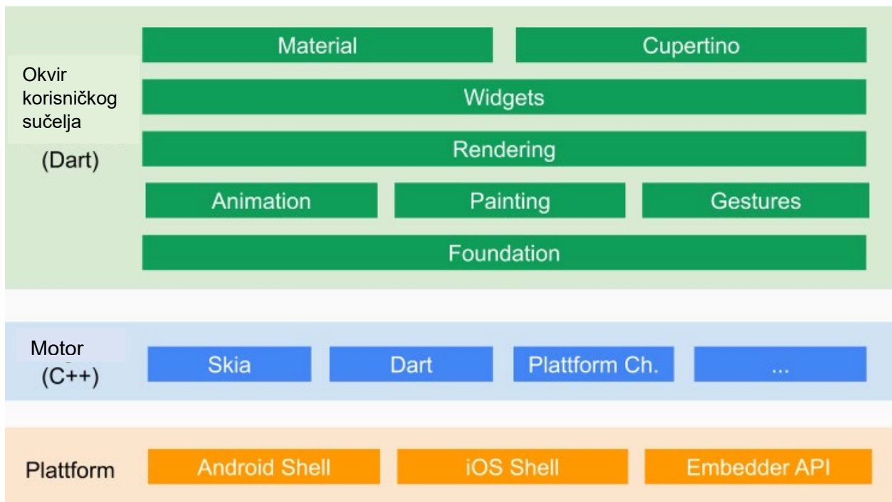
Slika 3.2 Arhitektura Flutter sustava
