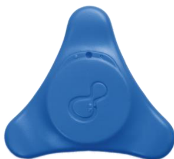
Slika 10.6. ADAMM nosivi monitor [29]
