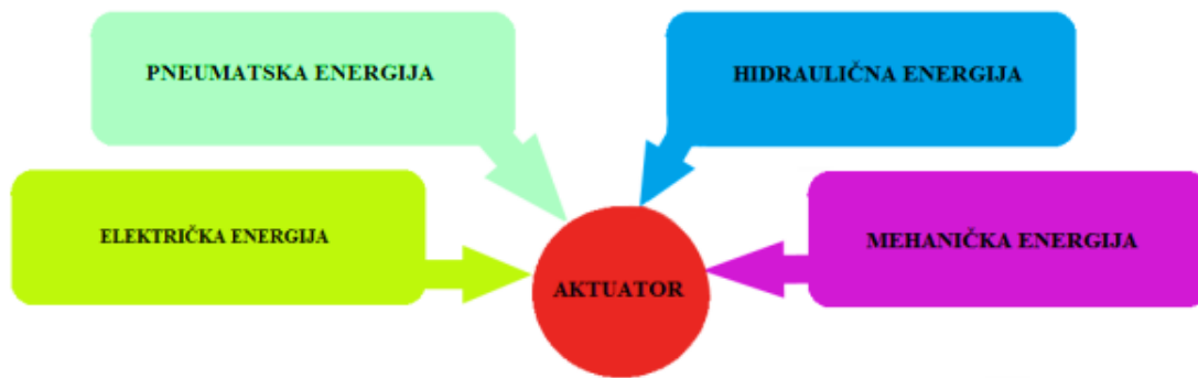
Slika 5.1. Podjela aktuatora s obzirom na vrstu ulazne energije
