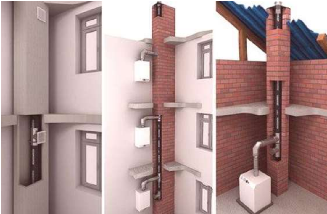
Slika 2.5. Postavljanje dimnjaka na plinski kotao, [10]
