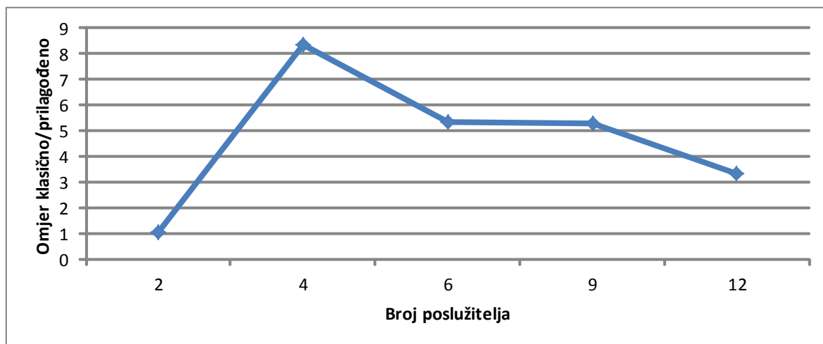
Slika 6.9: Grafički prikaz omjera vremena, izvođenja Kombinirane metode za prvi scenarij, klasičnog i prilagođenog modela skladišta.
