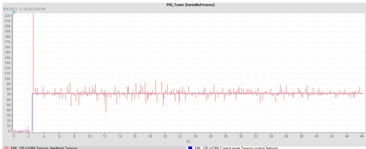
Sl. 3.24. Trenutna i zadana vrijednost napetosti trake, K_p = 0.04 , K_i = 0.0085 .
