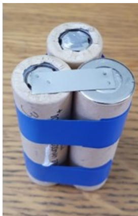
Slika 7.5.3. Zavarene baterije s jedne i druge strane (a)
