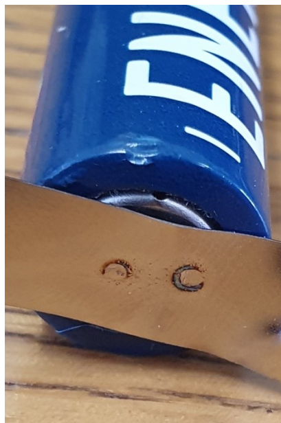
Slika 7.3.2. Spoj napravljen korištenjem 4 pulsa i razine jakosti struje 4,5
