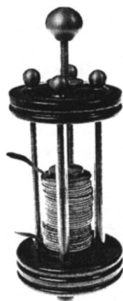
Slika 4.2.1. Prikaz originalne Volta "hrpe" [7]
