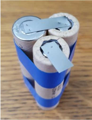
Slika 7.5.4. Zavareni plus i minus izvoda (a)
