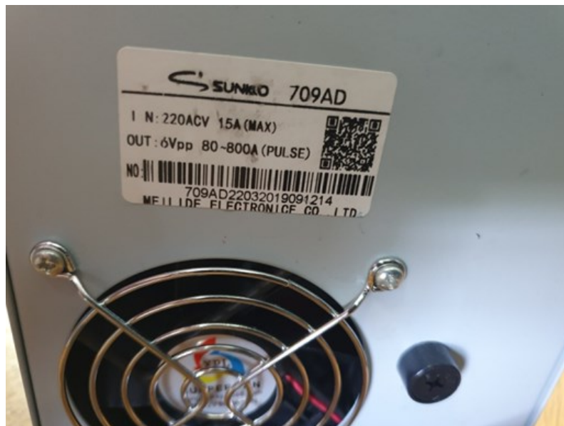
Slika 7.1.3. Nazivna pločica aparata za točkasto zavarivanje
