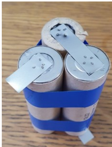
Slika 7.5.5. Izrađen serijski baterijski spoj s dodatnim točkastim zavarom
