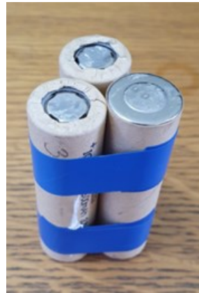
Slika 7.5.2. Pričvršćene baterije u željenom obliku
