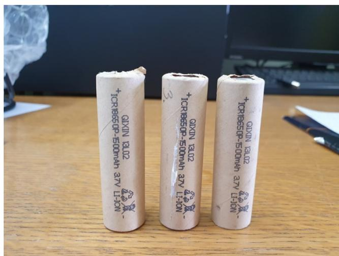
Slika 7.5.1. Tri litij-ionske baterije 18650 korištene za izradu serijskog baterijskog spoja
