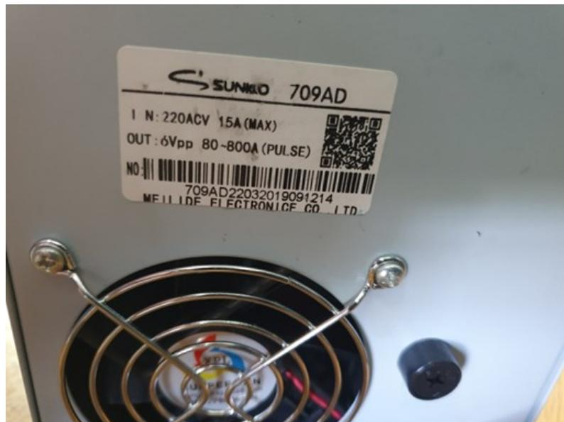
Slika 7.1.3. Nazivna pločica aparata za točkasto zavarivanje
