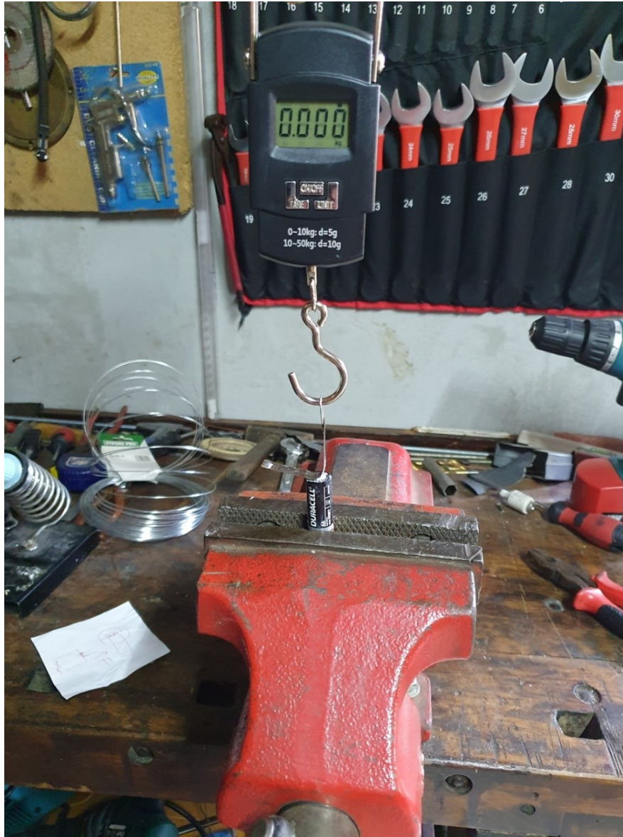
Slika 7.4.1. Postava za ispitivanje kvalitete spoja korištenjem dinamometra i škripca
