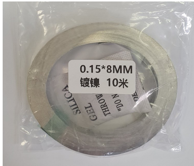
Slika 4.5.1. Korištena trakica nikla
