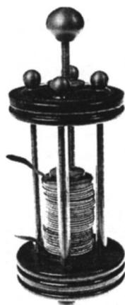
*Slika 4.2.1. Prikaz originalne Volta "hrpe" [7]*
