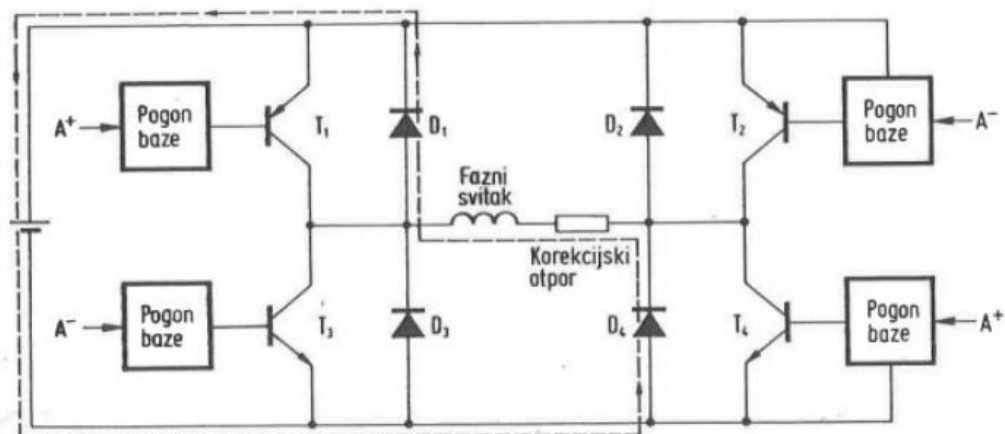
Slika 8.2. Krug za dvosmjernu pobudu svake pojedine faze motora s ugrađenim permanentnim magnetom [1]
