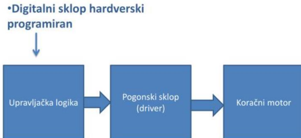
Slika 7.1. Blok prikaz koračnog pogona[10]
