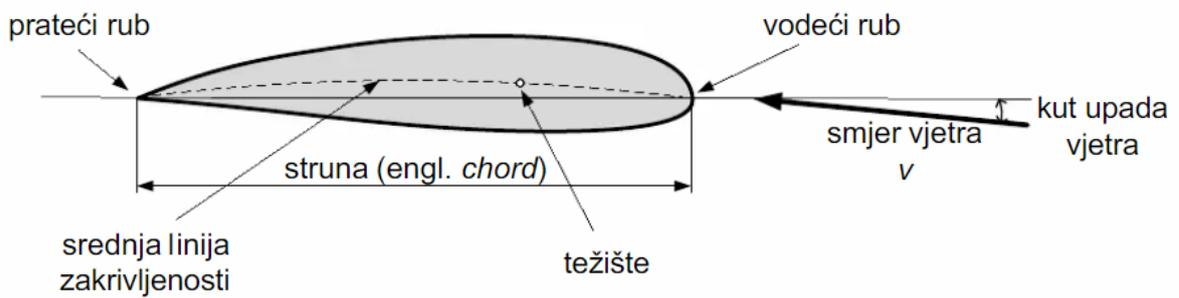
Slika 7. Poprečni presjek tipične lopatice vjetroelektrane [4]
