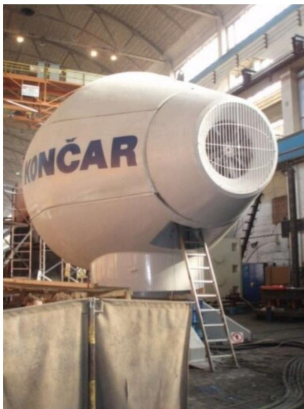
*Slika 16. Izrada vjetrogeneratora hrvatske proizvodnje [6]*
