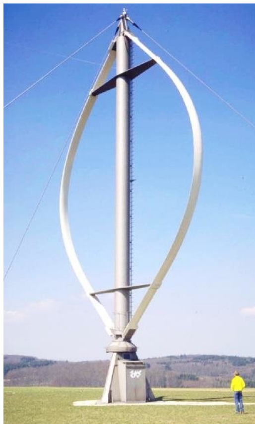
Slika 4. Vjetrogenerator s okomitom osi vrtnje [2]
