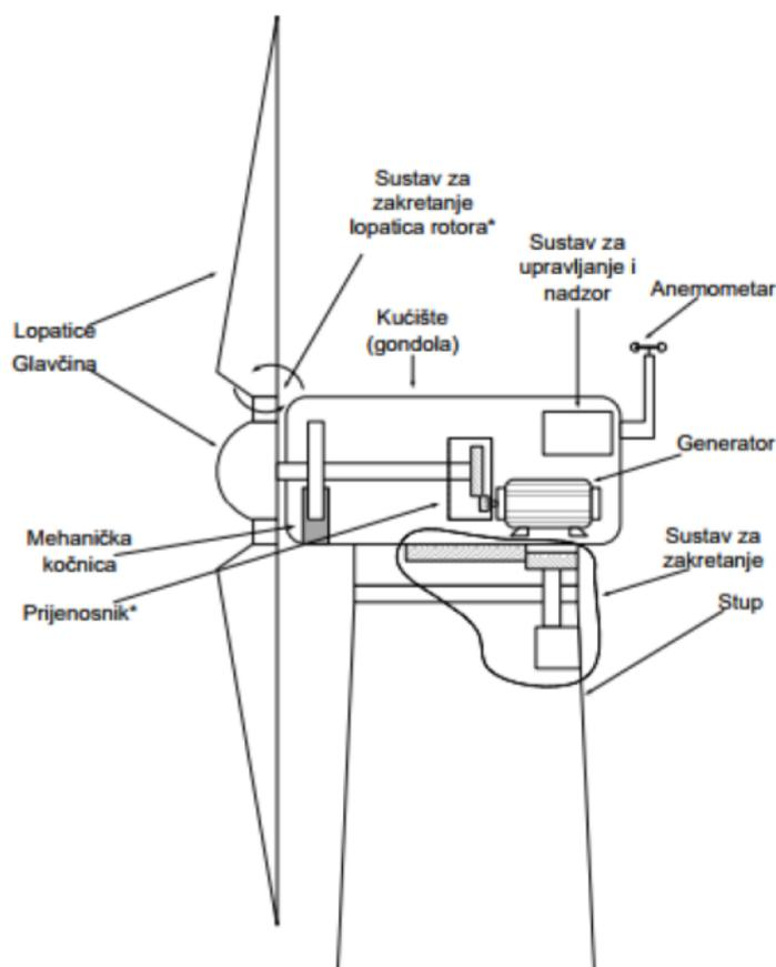
Slika 5. Osnovni dijelovi vjetrogeneratora [4]
