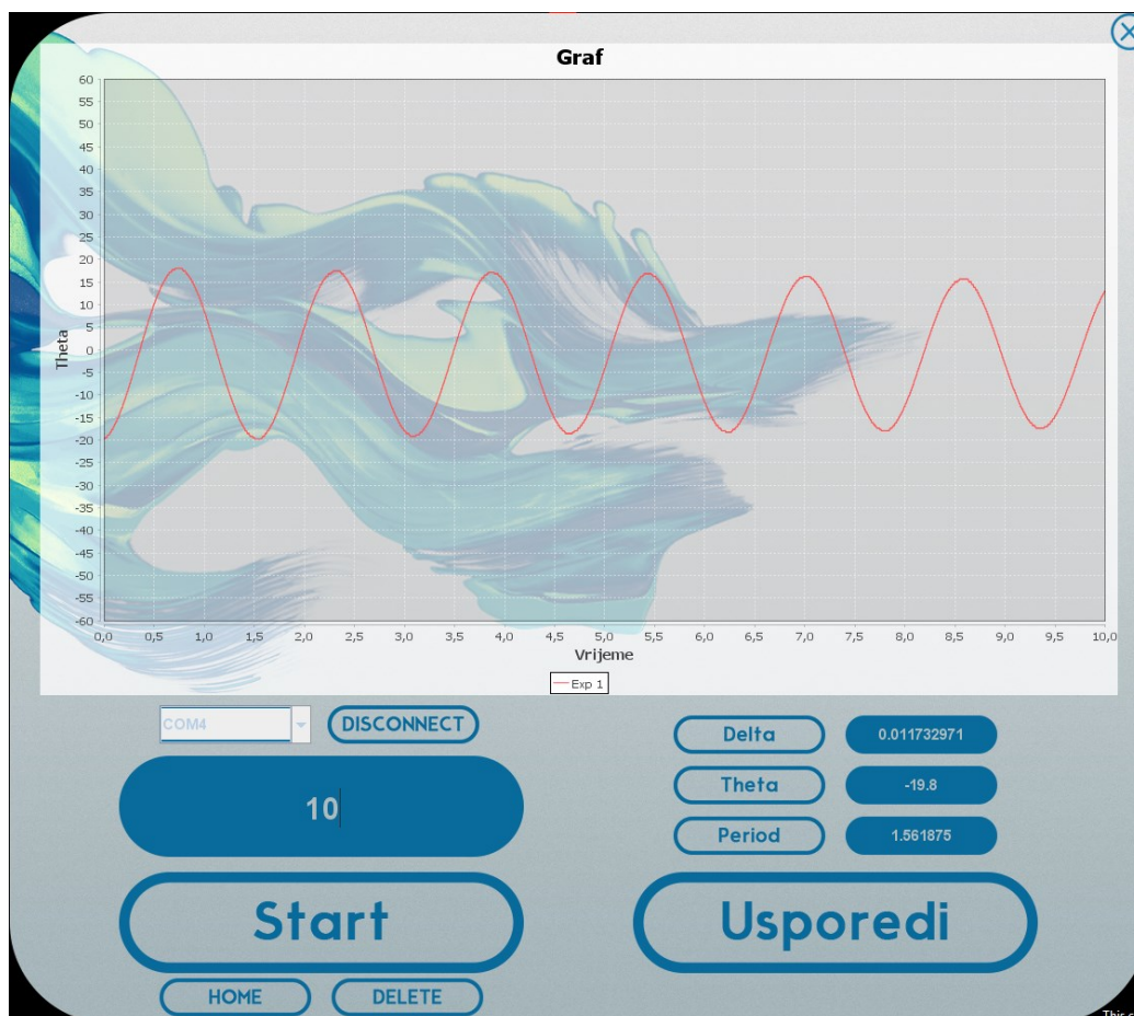
Slika 6.14. Prikaz kutne elongacije fizikalnog njihala u ovisnosti o vremenu [11]
