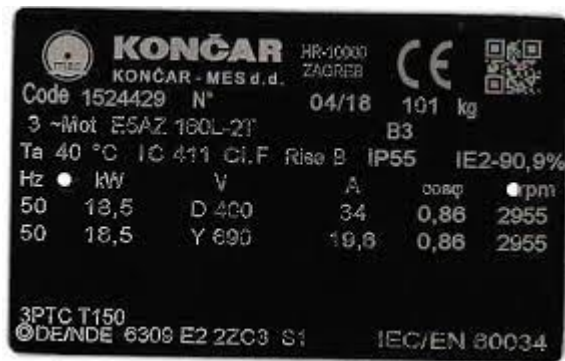
Sl. 2. 8. Prikaz natpisne pločice motora
