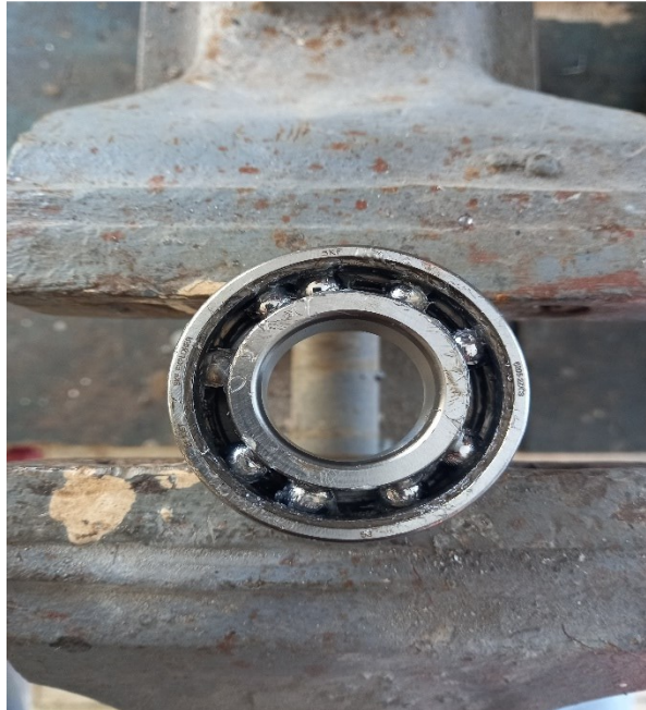
Slika 5.10: Namjerno oštećeni ležaj.
