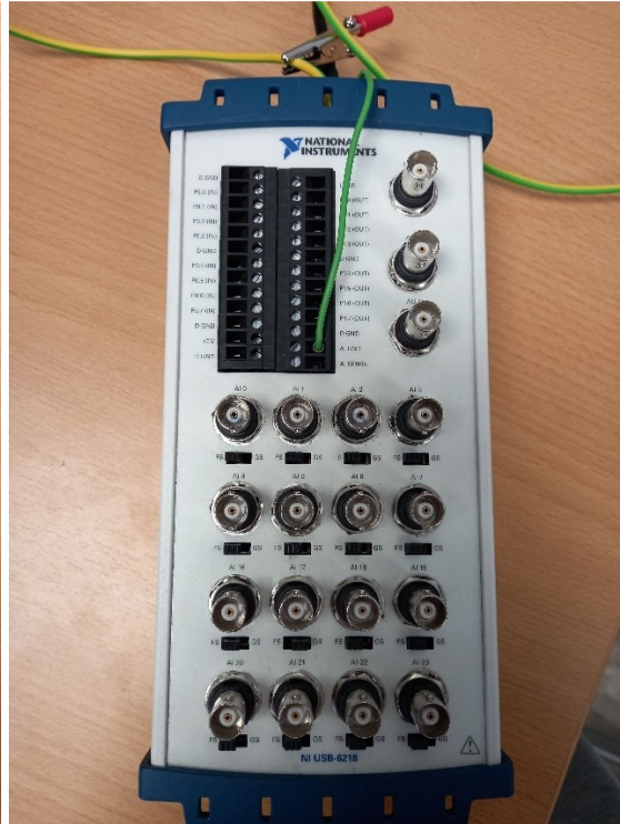
Slika 5.4. National instruments NI USB-6218 kartica
