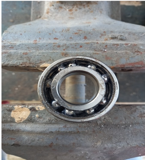
Slika 5.10: Namjerno oštećeni ležaj.
