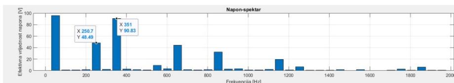
Slika 6.26. Harmonijski sadržaj linijskog napona
