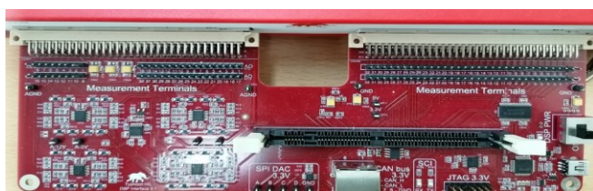
Slika 5.4. Vanjsko sučelje s IN/OUT pinovima
