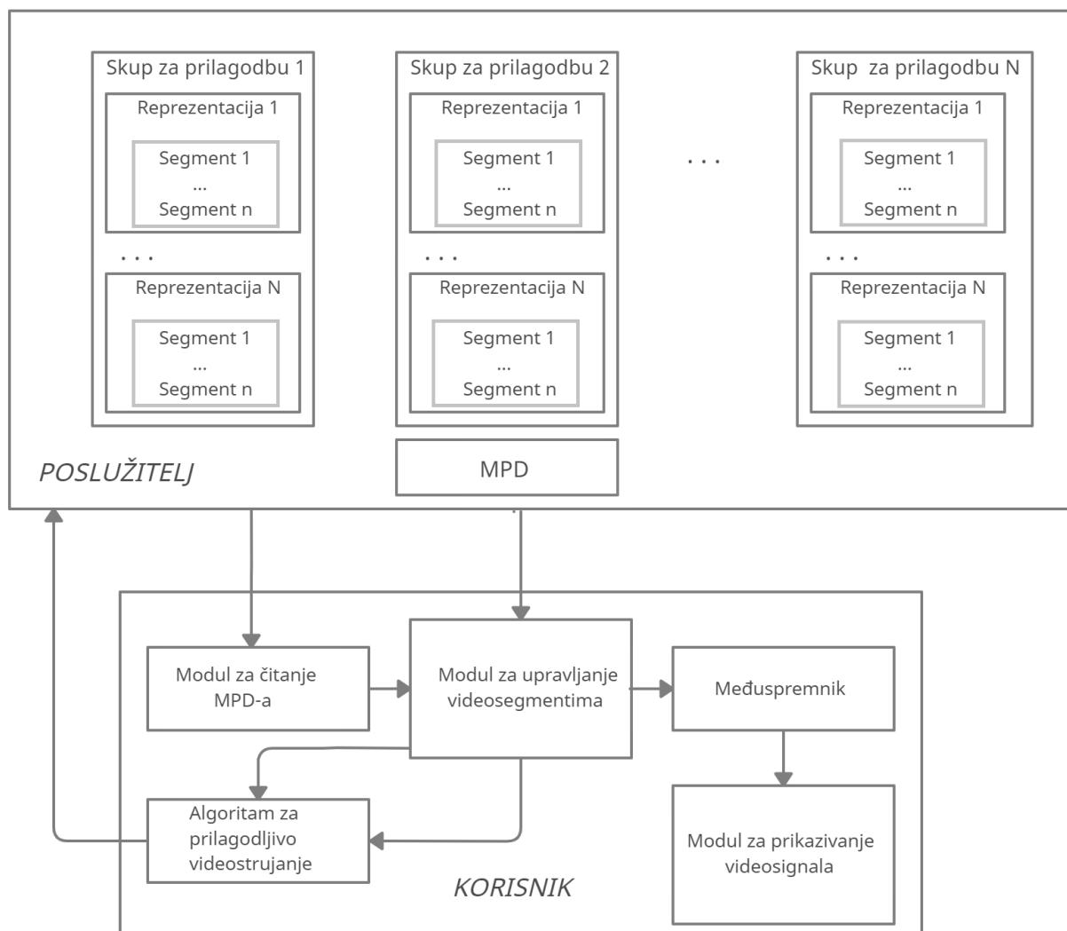
Slika 2.1. Arhitektura sustava zasnovanog na MPEG DASH normi
