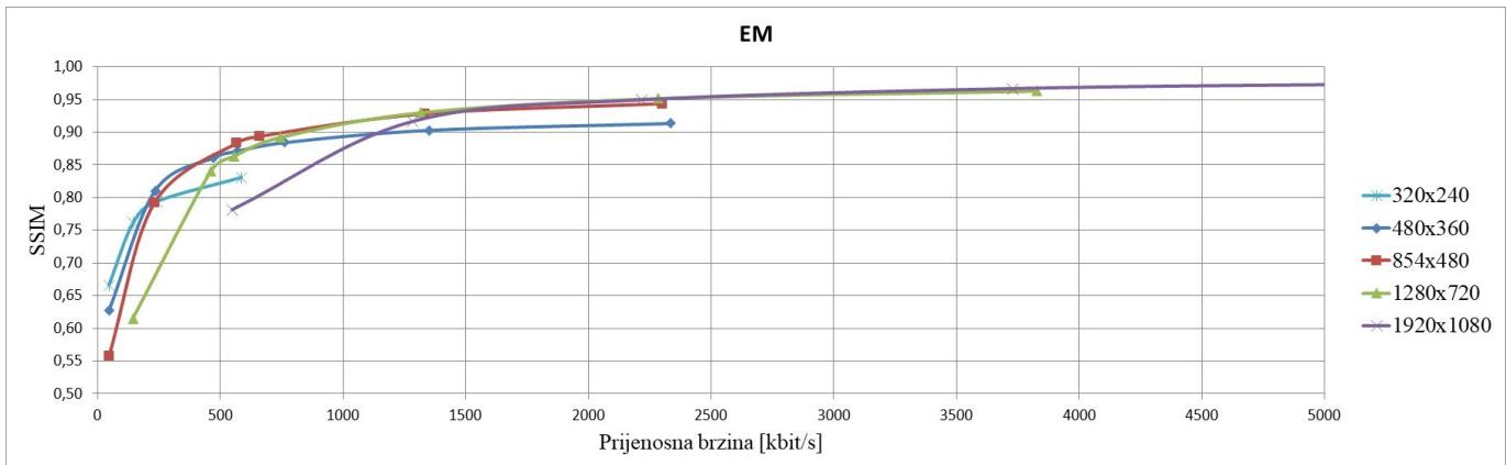
Slika 4.6. Krivulje ovisnosti SSIM-a o prijenosnoj brzini za *El Fuente Mask* videosignal kodiran na odabranim prostornim rezolucijama: 240p, 360p, 480p, 720p i 1080p
