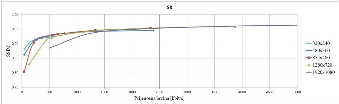
Slika 4.5. Krivulje ovisnosti SSIM-a o prijenosnoj brzini za *Skateborading* videosignal kodiran na odabranim prostornim rezolucijama: 240p, 360p, 480p, 720p i 1080p
