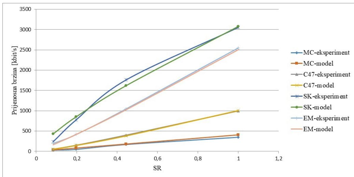
Slika 4.16. Krivulje ovisnosti optimalnih vrijednosti prijenosnih brzina i relativne prostorne rezolucije određene pomoću predložene metode i pomoću izmjerih podataka.
