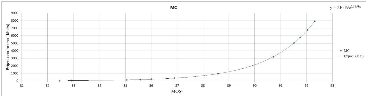
Slika 4.26. Krivulja ovisnosti prijenosne brzine o vrijednosti  $MOS^p$  *Meridian Conversation* (MC).
