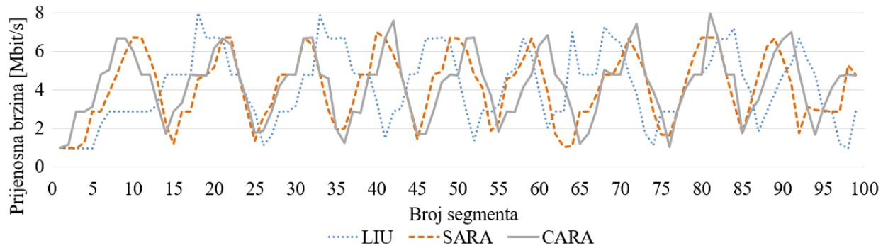
Slika 2.9. Postignuta prijenosna brzina za svaki dio videosignalata *Big Buck Bunny* za mrežni ispitni zapis 3.
