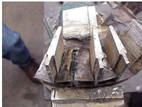
**Slika 5.5.** *Detalj oštećenja kaveza na spoju štapa i prstena*
