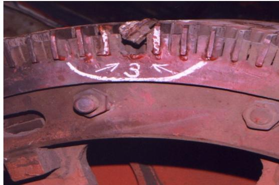
**Slika 5.2.** *Oštećenje kaveznog rotora*
