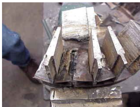
Slika 5.5. Detalj oštećenja kaveza na spoju štapa i prstena
