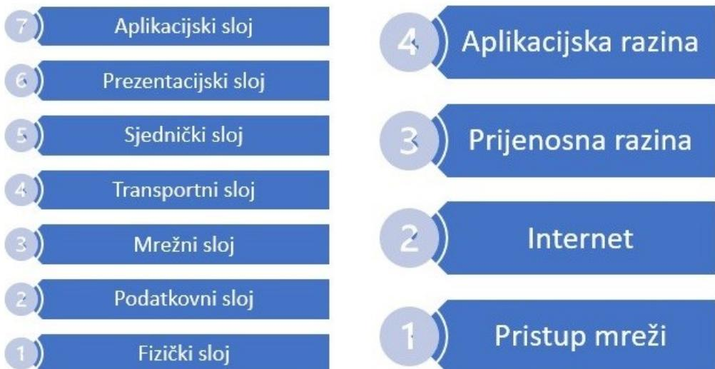
**Slika 3. Odnos OSI referentnog modela i TCP/IP arhitekture**
