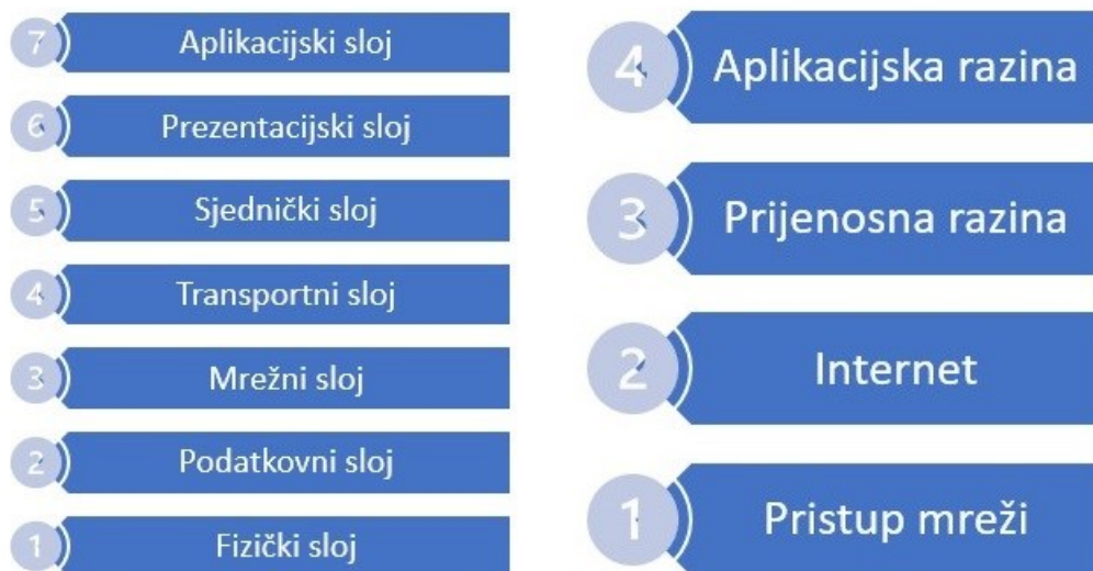
Slika 3. Odnos OSI referentnog modela i TCP/IP arhitekture
