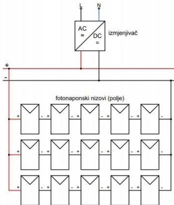
**Slika 3.9.** Izvedba s jednim izmjenjivačem [9]
