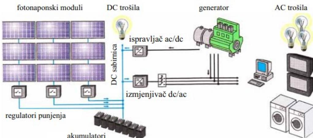
**Slika 3.14.** Hibridni fotonaponski sustavi [10]
