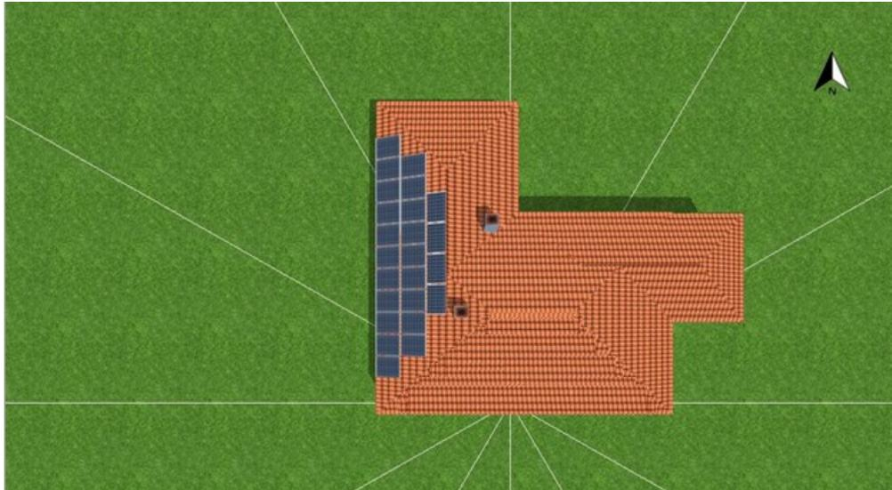
*Slika 4.3.* Projekt klasične fotonaponske elektrane u PV SOL-u
