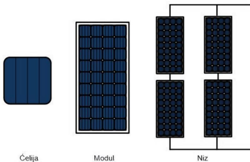
**Slika 3.2.** Fotonaponska ćelija te njihovo povezivanje u module i nizove [8]
