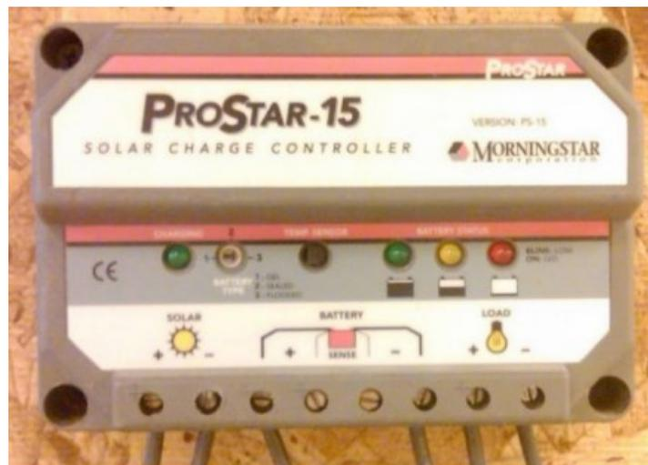
*Slika 3.7.* Regulator punjenja u fotonaponskom sustavu [11]
