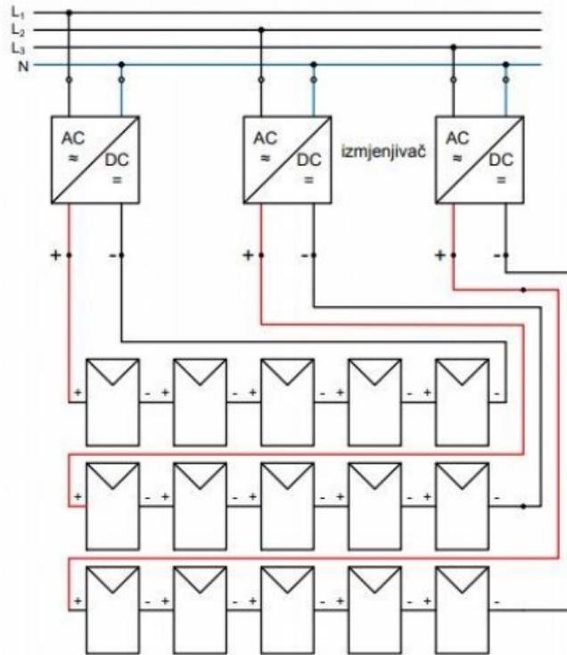
**Slika 3.10.** Izvedba s jednim izmjenjivačem za svaki niz [9]
