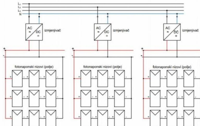
**Slika 3.11.** Izvedba s jednim izmjenjivačem za svaki niz [9]
