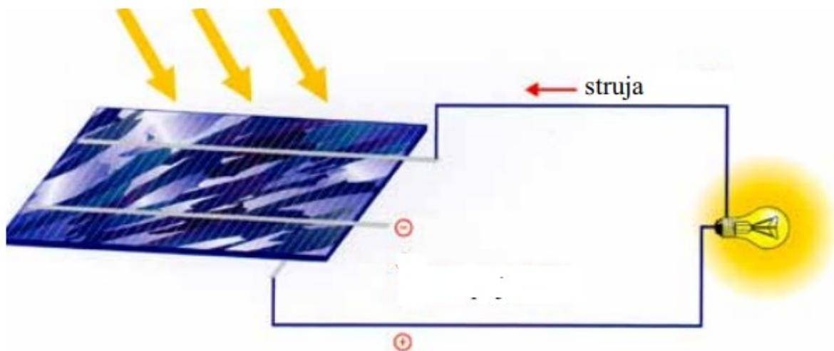
*Slika 3.1.* Ilustracija fotonaponskog efekta [7]
