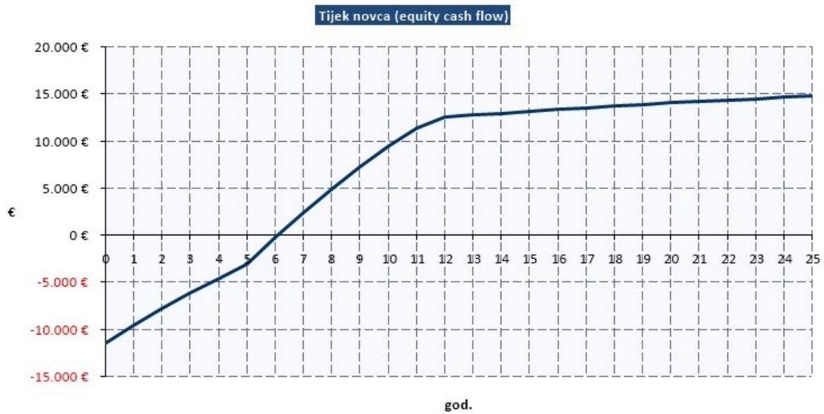
**Slika 6.2.** Prikaz vremena povrata klasične fotonaponske elektrane
