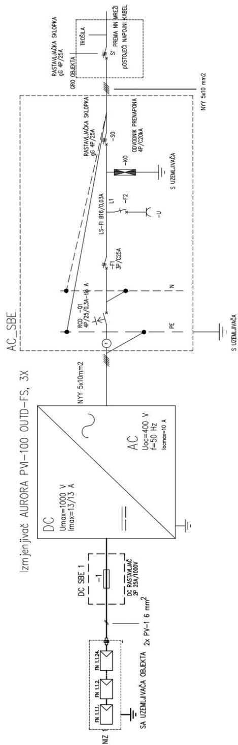
Slika 4.5. Jednopolna shema sustava
