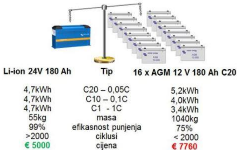
Slika 4.4 Usporedba dvije vrste baterija [14]
