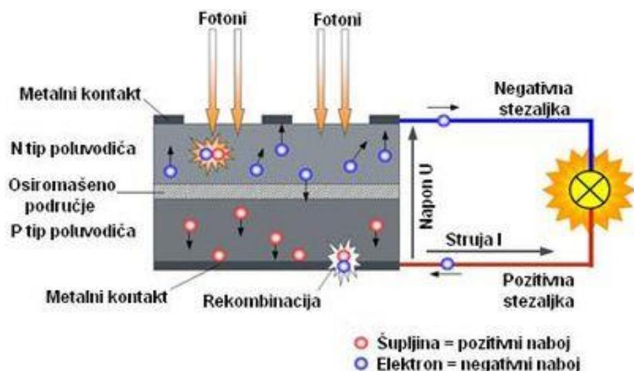
Slika 3.3. Fotonaponski efekt [1]
