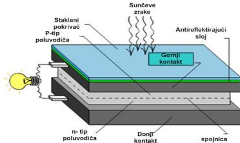
**Slika 3.2 Fotonaponska ćelija [10]**
