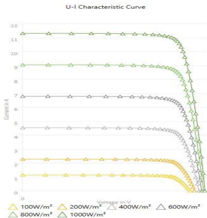
**Slika 6.3 Ovisnost struje o naponu panela [6]**
