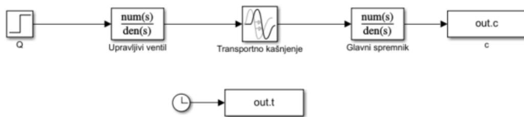
Sl. 4.3. Blokovski prikaz linearnog sustava upravljanja.
