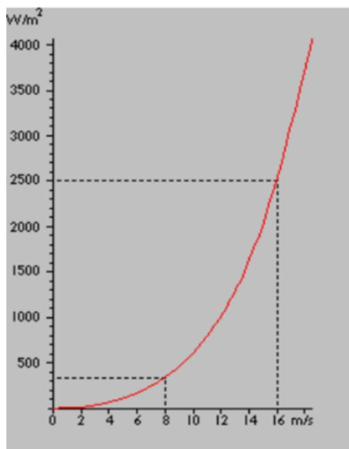
Slika 3.4. Porast snage vjetra sa brzinom [14]
