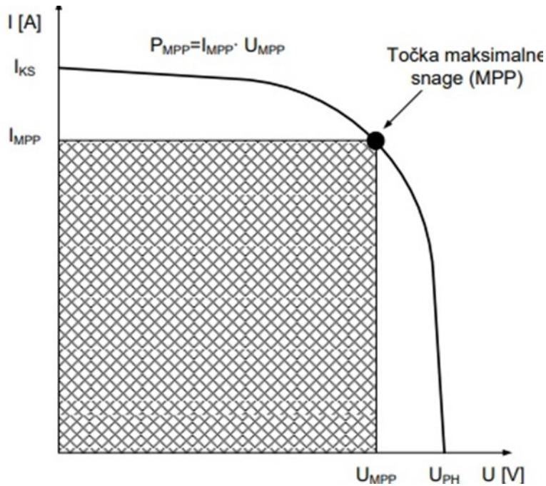
**Slika 3.6.** U/I karakteristika FN ćelije pod osvjetljenjem [16]
