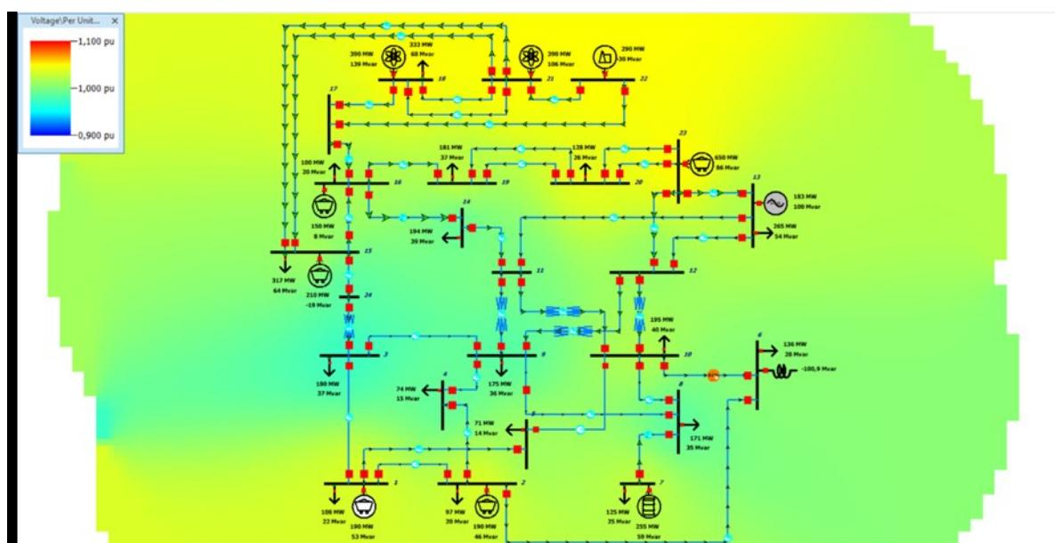
**Slika 6.2.** Simulirani napon u sustavu obojan pomoću funkcije contouring
