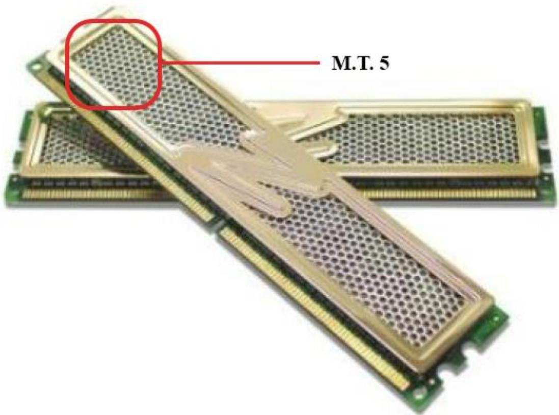
Sl. 4.1. RAM pločica i mjerna točka [7]
