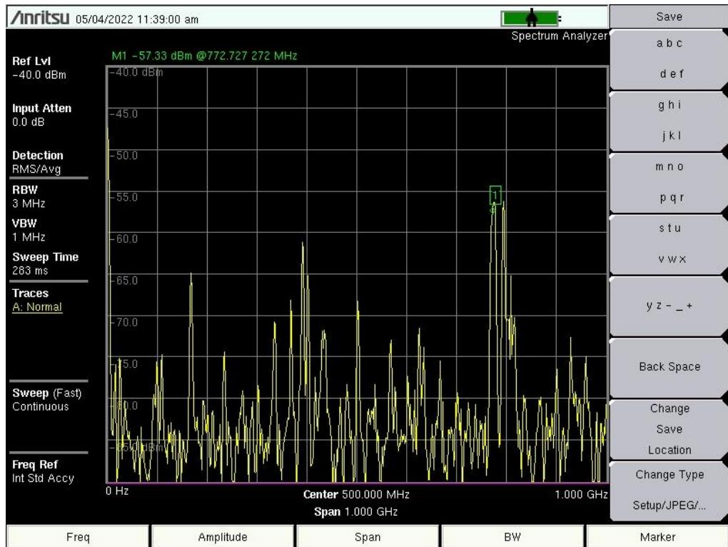
Sl. 8.11. Spektrogram električnog polja mjereno paralelno u ovisnosti o frekvenciji koristeći sondu PBS-E1 u mjernoj točki 6
