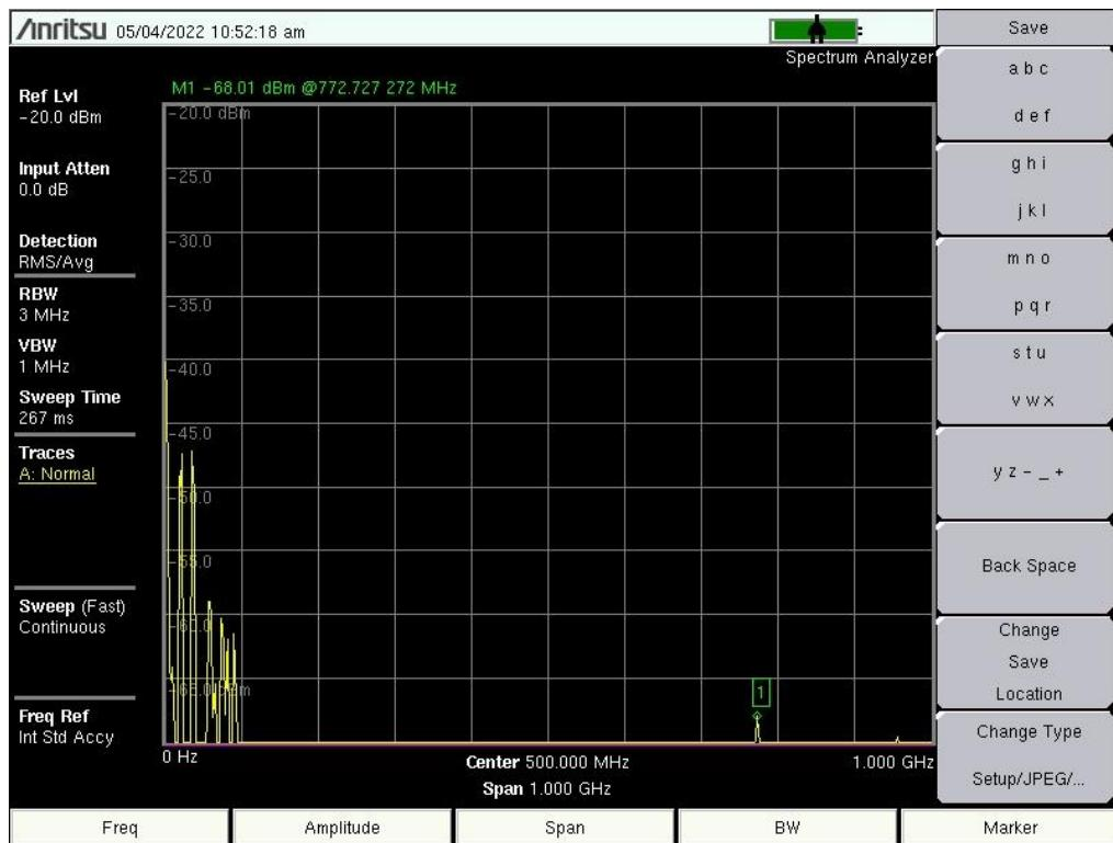
Sl. 8.21. Spektrogram magnetskog polja mjereno u okomito u ovisnosti o frekvenciji koristeći sondu PBS-H3 u mjerenoj točki 6
