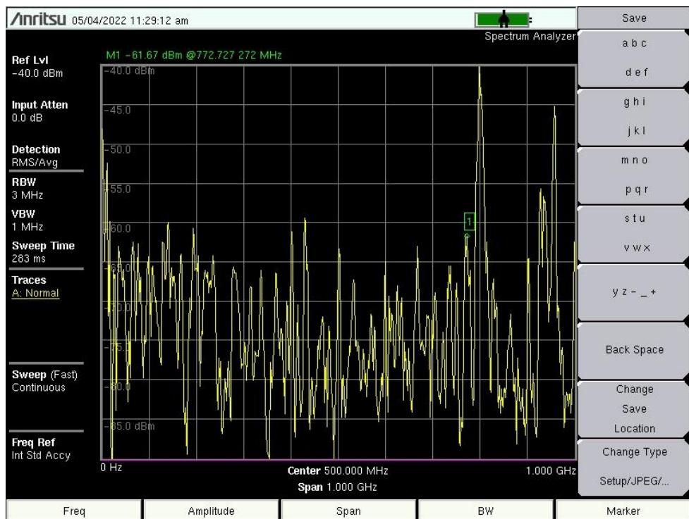
Sl. 4.17 Mjerenje magnetskog polja okomito u ovisnosti o frekvenciji koristeći sondu PBS-H4 u mjernoj točki 7
