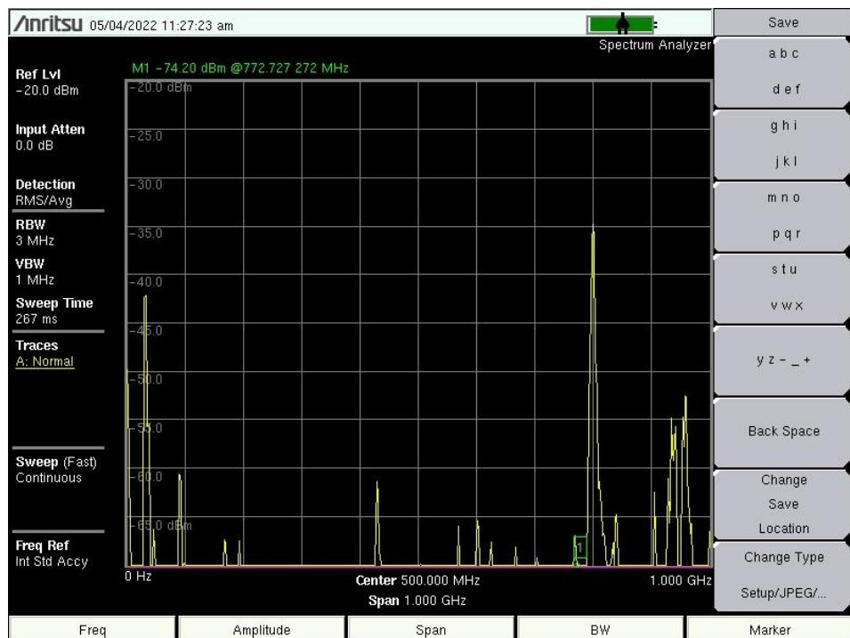
Sl. 4.15. Mjerenje magnetskog polja paralelno u ovisnosti o frekvenciji koristeći sondu PBS-H4 u mjernoj točki 6
