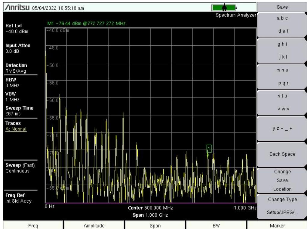
Sl. 8.9. Spektrogram magnetskog polja mjereno paralelno u ovisnosti o frekvenciji koristeći sondu PBS-H3 u mjernoj točki 4
