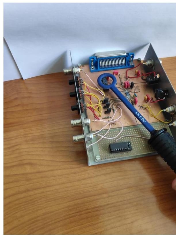
Sl. 4.10. Primjer horizontalnog mjerena električne komponente magnetskom sondom PBS-H3
