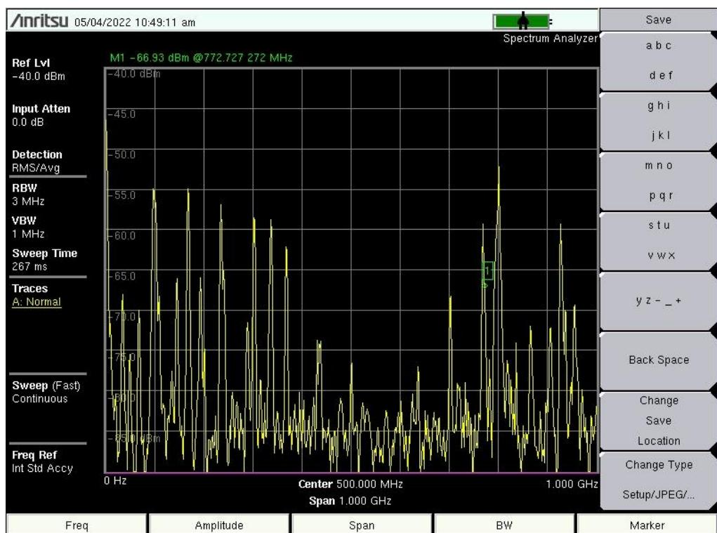
Sl. 8.16 Spektrogram magnetskog polja mjereno okomito u ovisnosti o frekvenciji koristeći sondu PBS-H3 u mjernoj točki 1
