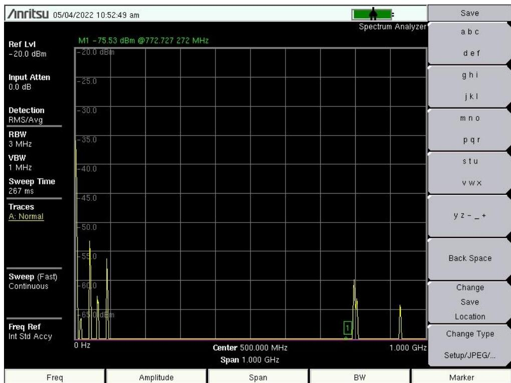
Sl. 8.12 Spektrogram magnetskog polja mjereno paralelno u ovisnosti o frekvenciji koristeći sondu PBS-H3 u mjernoj točki 6
