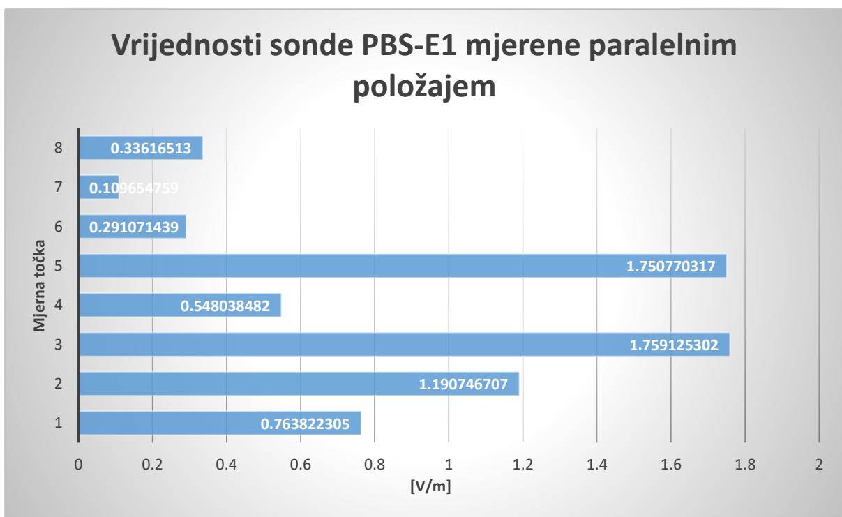
Sl. 4.23. Graf električne sonde PBS-E1 mjereno u paralelnom položaju
