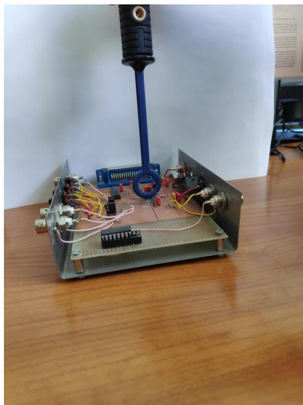
Sl. 4.9. Primjer okomitog mjerena električne komponente magnetskom sondom PBS-H3
