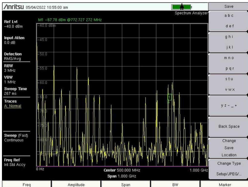
Sl. 8.4 Spektrogram magnetskog polja mjereno paralelno u ovisnosti o frekvenciji koristeći sondu PBS-H3 u mjernoj točki 1
