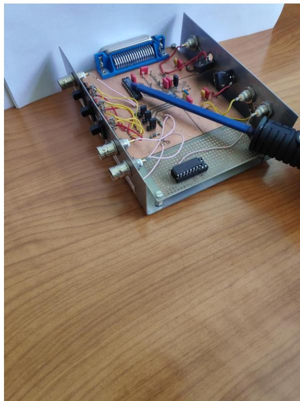
Sl. 4.8. Primjer horizontalnog mjerenja električne komponente električnom sondom PBS-E1
