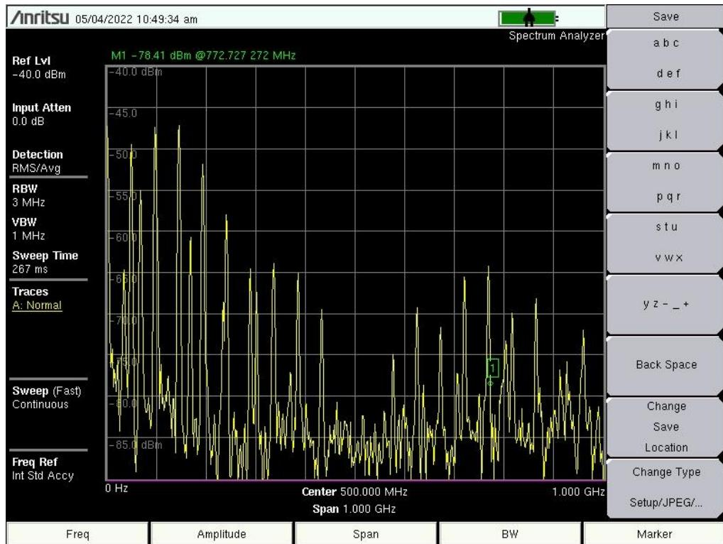
Sl. 8.17. Spektrogram magnetskog polja mjereno okomito u ovisnosti o frekvenciji koristeći sondu PBS-H3 u mjernoj točki 2
