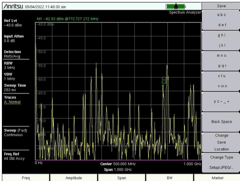
Sl. 8.3.Spektrogram električnog polja mjereno paralelno u ovisnosti o frekvenciji koristeći sondu PBS-E1 u mjernoj točki 1
