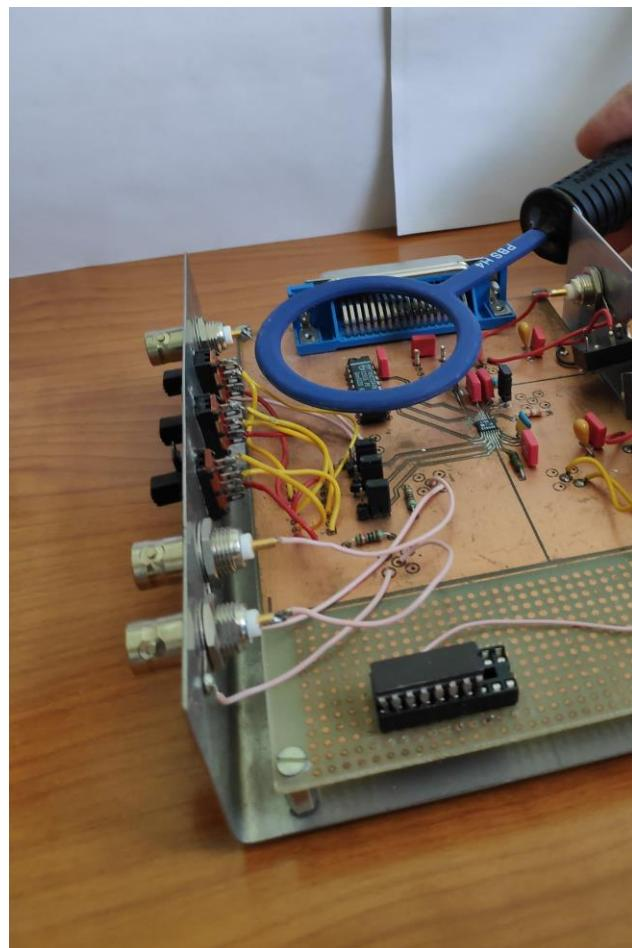
Sl. 4.12. Primjer horizontalnog mjerenja električne komponente magnetskom sondom PBS-H4
