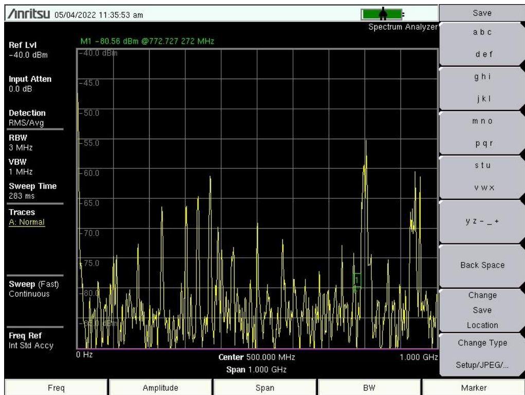
Sl. 8.15. Spektrogram električnog polja mjereno okomito u ovisnosti o frekvenciji koristeći sondu PBS-E1 u mjernoj točki 1
