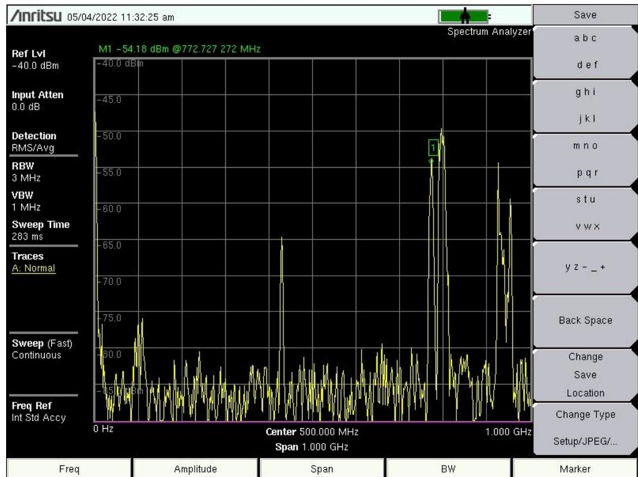
Sl. 4.13. Mjerjenje magnetskog polja u ovisnosti o frekvenciji koristeći sondu PBS-H4 u slobodnom prostoru
