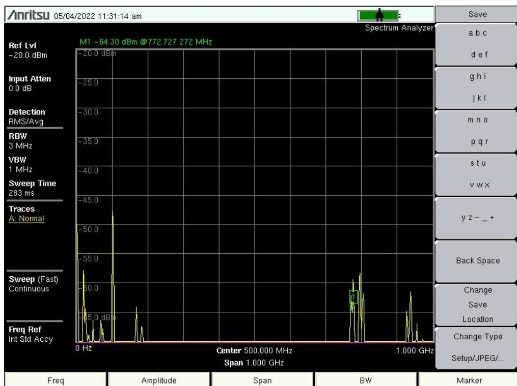
Sl. 8.22 Spektrogram magnetskog polja mjereno u okomito u ovisnosti o frekvenciji koristeći sondu PBS-H4 u mjerenoj točki 6
