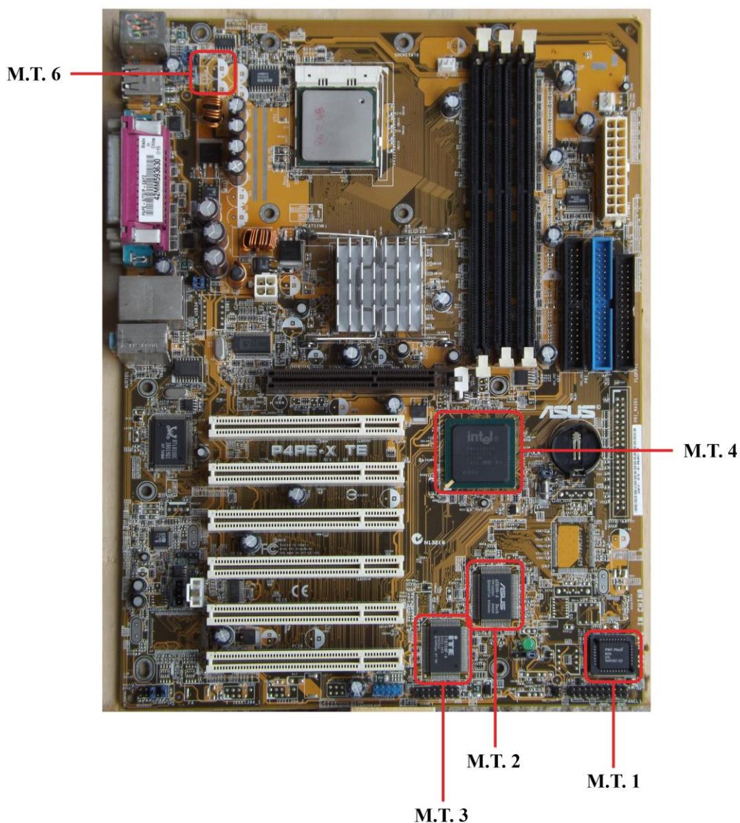
Sl. 4.2. Matična ploča i mjerne točke [8]
