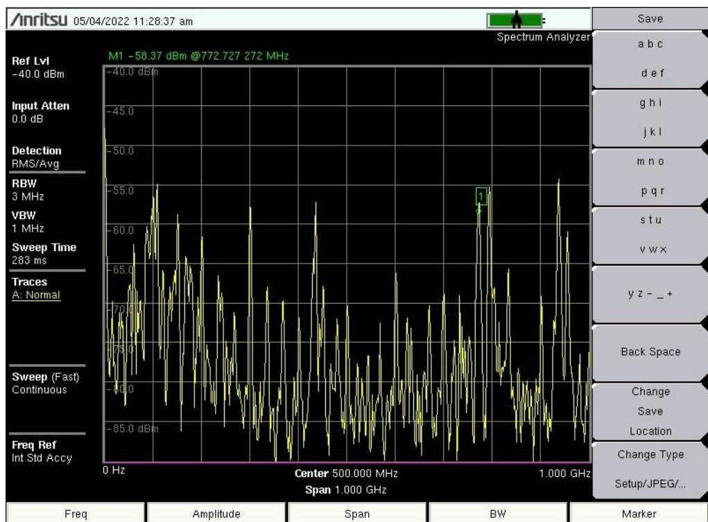
Sl. 8.14 Spektrogram magnetskog polja mjereno paralelno u ovisnosti o frekvenciji koristeći sondu PBS-H4 u mjernoj točki 8
