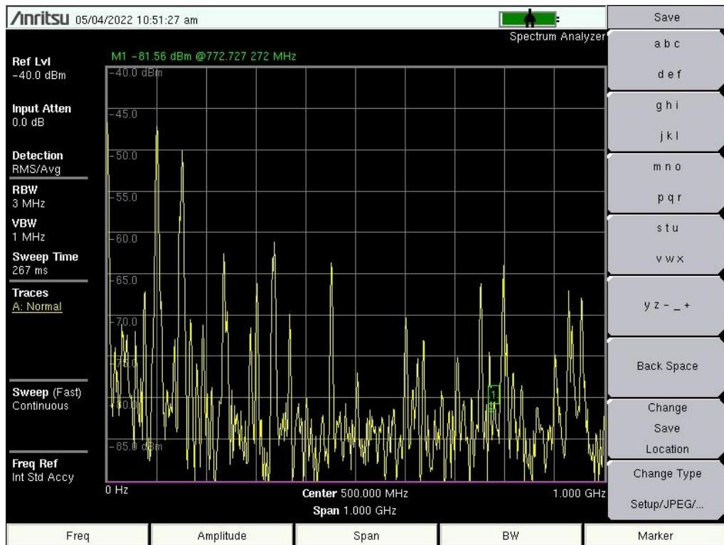
Sl. 8.24 Spektrogram magnetskog polja mjereno okomito u ovisnosti o frekvenciji koristeći sondu PBS-H3 u mjernoj točki 8
