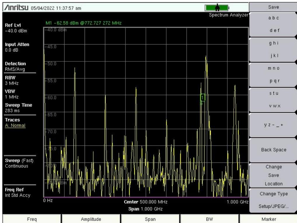
Sl. 8.23. Spektrogram električnog polja mjereno okomito u ovisnosti o frekvenciji koristeći sondu PBS-E1 u mjernoj točki 8
