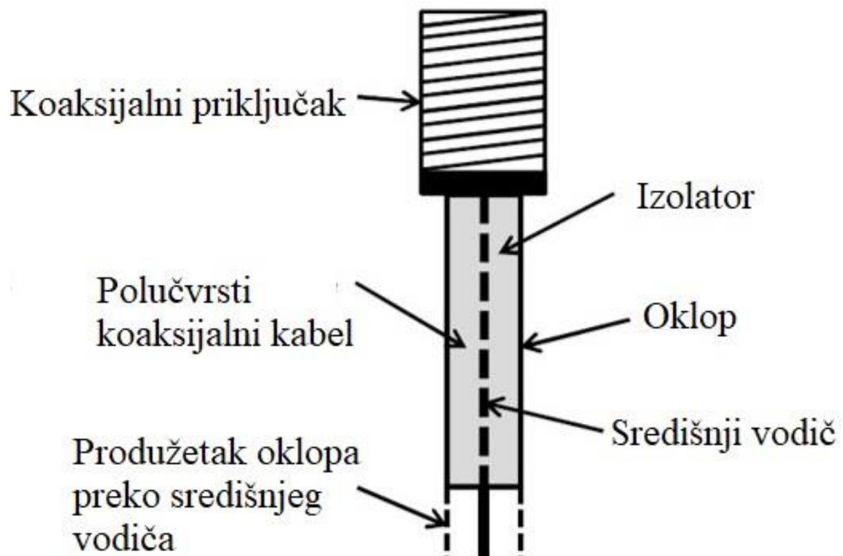
Sl. 4.5. Sonda za mjerjenje električnog polja
