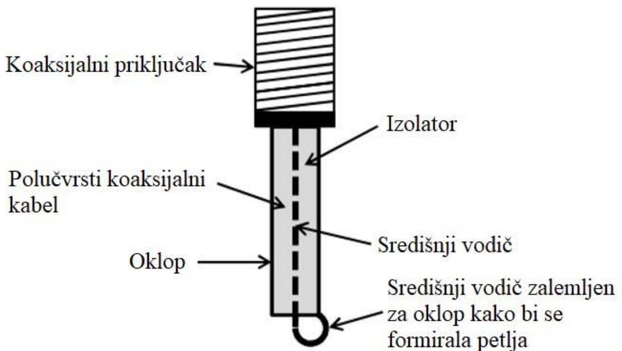
Sl. 4.6. Sonda za mjerjenje magnetskog polja [11]
