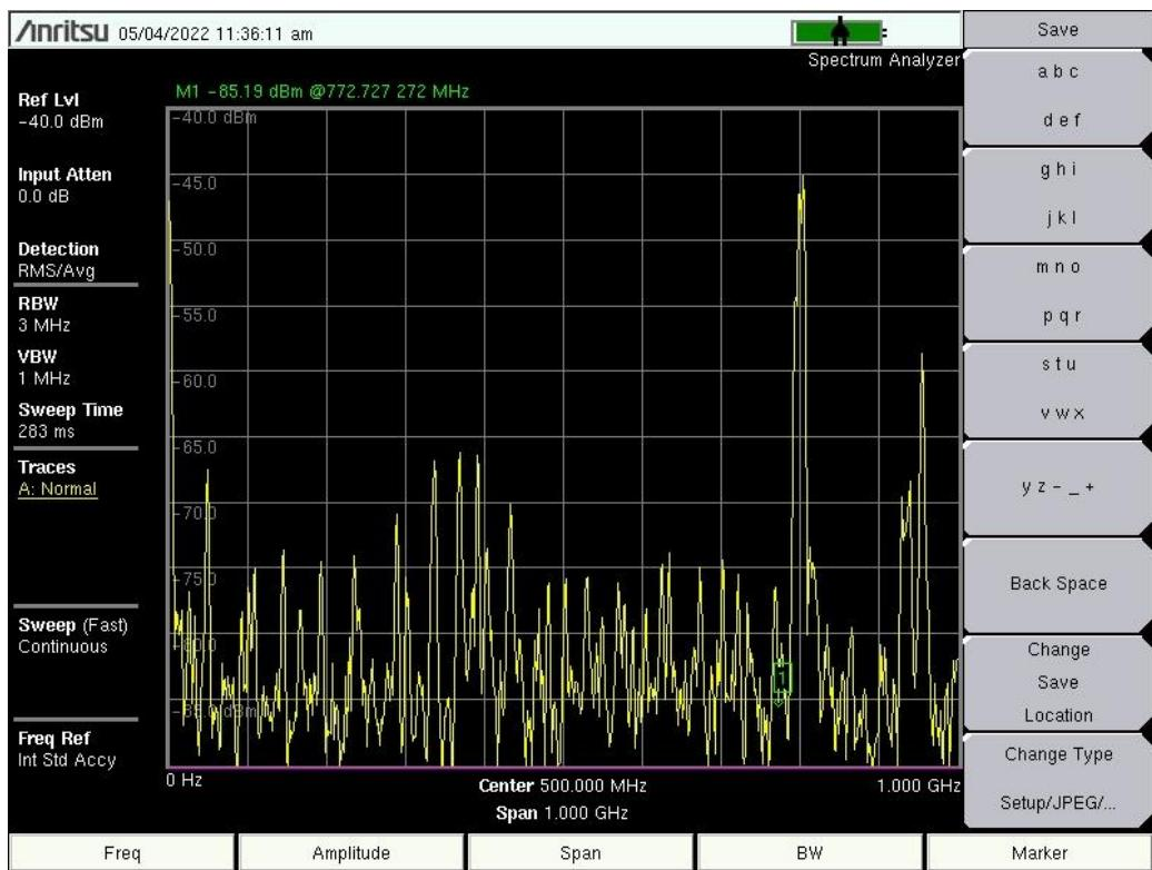
Sl. 4.16 Mjerenje električnog polja okomito u ovisnosti o frekvenciji koristeći sondu PBS-E1 u mjernoj točki 2
