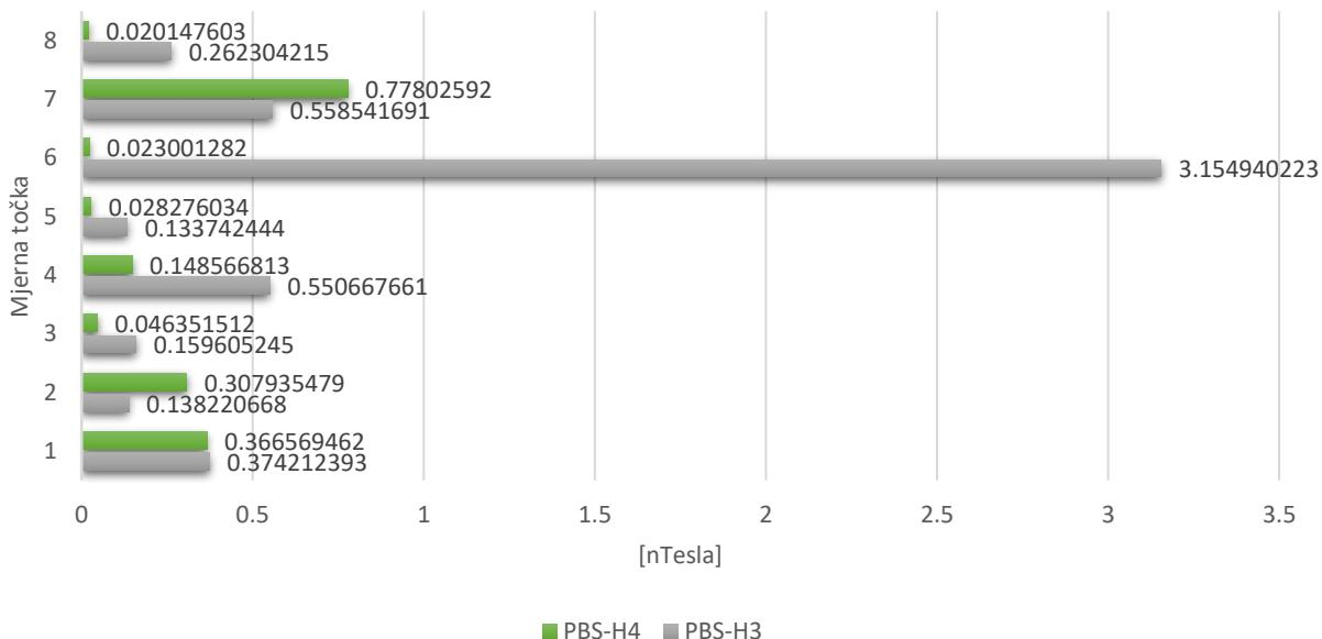
Sl. 4.27. Graf magnetskih sondi PBS-H3 i PBS-H4 koji uspoređuje maksimalne vrijednosti izmjerene okomito u mjernim točkama.
