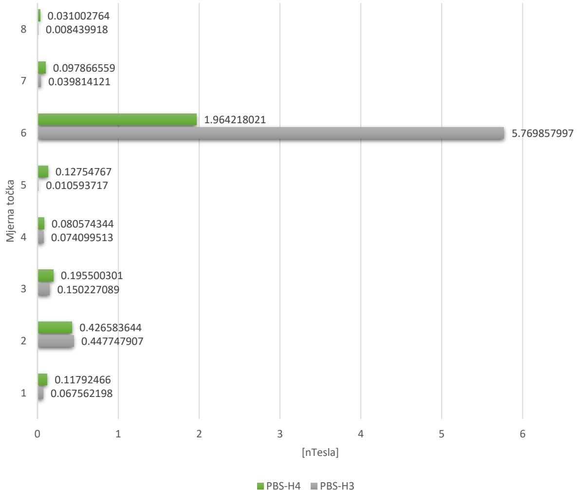
Sl. 4.28. Graf magnetskih sondi PBS-H3 i PBS-H4 koji uspoređuje maksimalne vrijednosti izmjerene paralelno u mjernim točkama.
