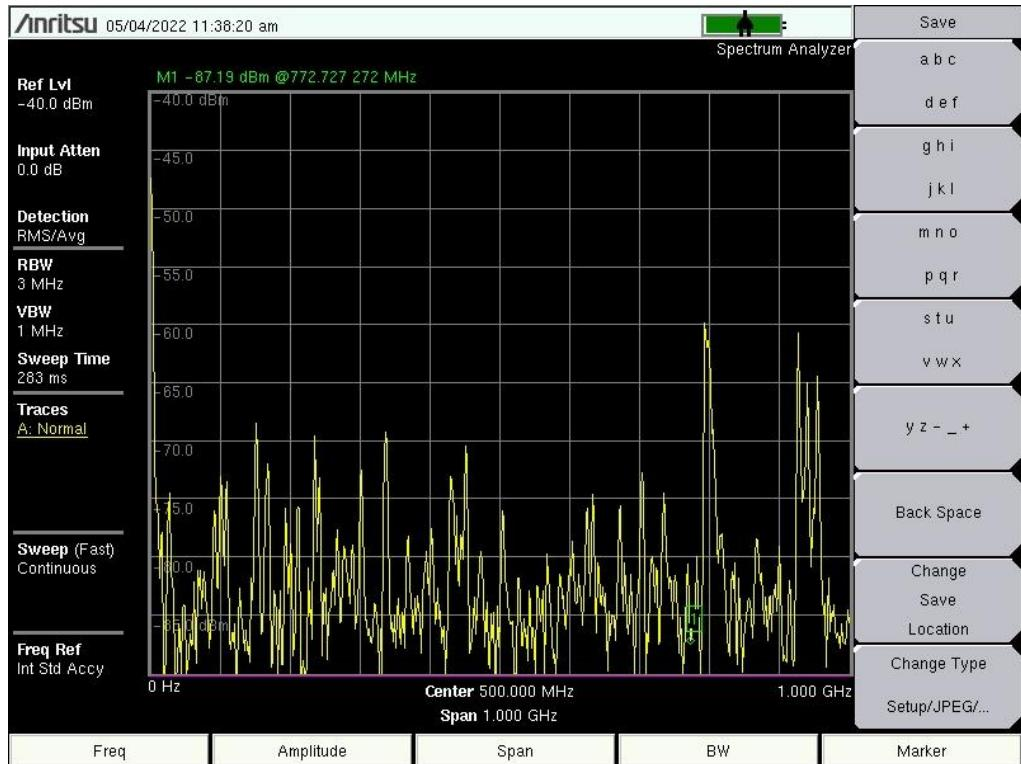
Sl. 8.13. Spektrogram električnog polja mjereno paralelno u ovisnosti o frekvenciji koristeći sondu PBS-E1 u mjernoj točki 8
