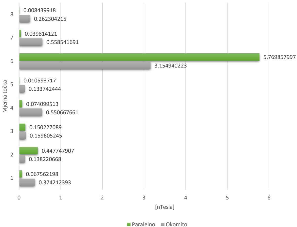
S1. 4.25. Graf magnetske sonde PBS-H3 koji uspoređuje maksimalne vrijednosti izmjerene okomito i paralelno u mjernim točkama.
