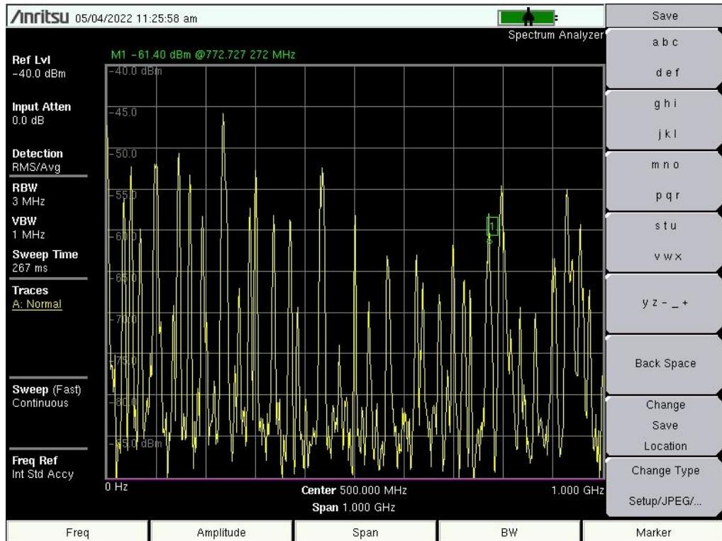
Sl. 8.5. Spektrogram magnetskog polja mjereno paralelno u ovisnosti o frekvenciji koristeći sondu PBS-H4 u mjernoj točki 1
