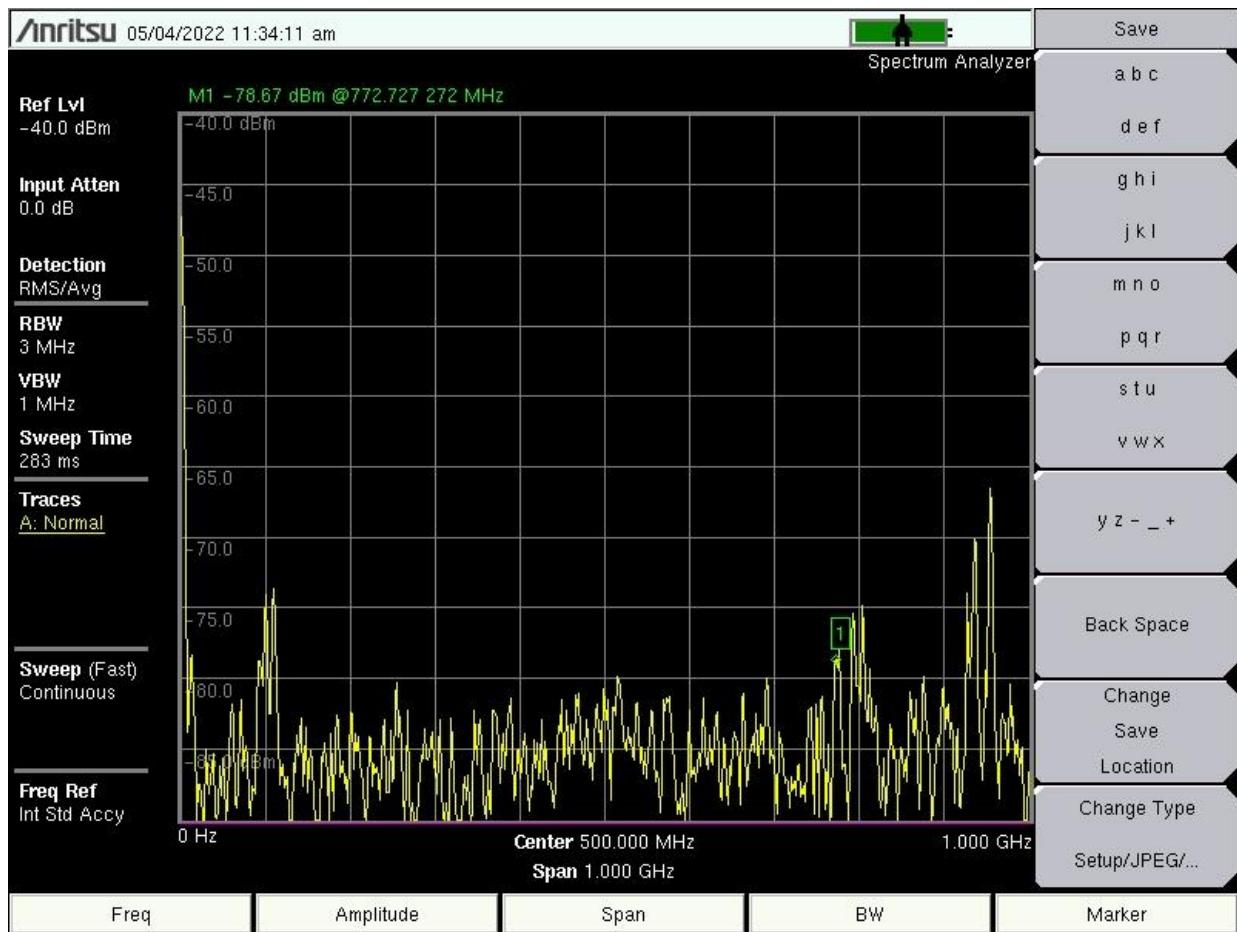
Sl. 8.25. Spektrogram električnog polja u ovisnosti o frekvenciji koristeći sondu PBS-E1 u slobodnome prostoru
