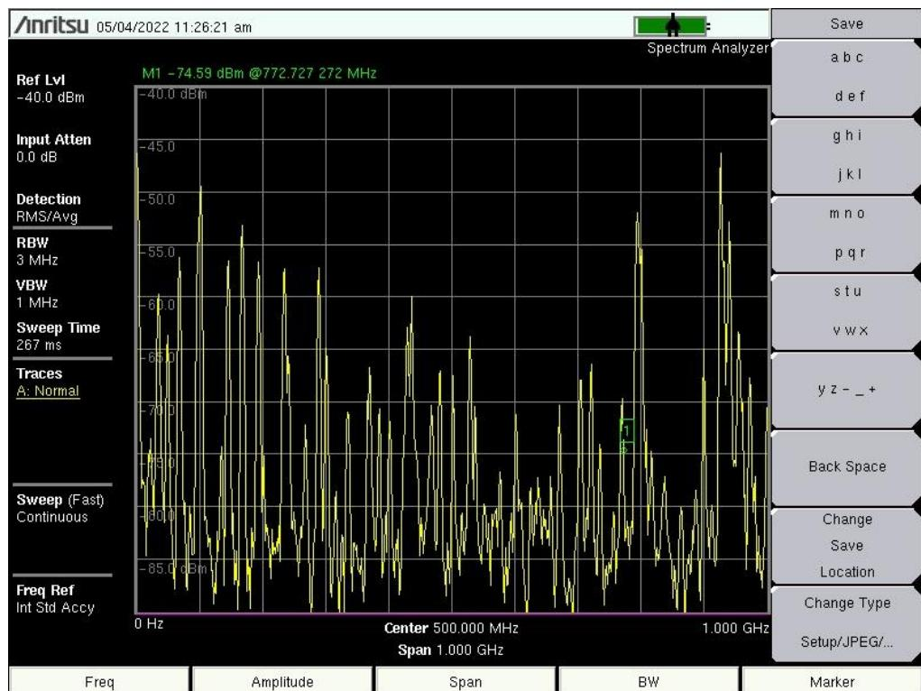
Sl. 8.10 Spektrogram magnetskog polja mjereno paralelno u ovisnosti o frekvenciji koristeći sondu PBS-H4 u mjernoj točki 4
