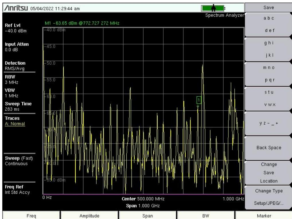
Sl. 8.20 Spektrogram magnetskog polja mjereno okomito u ovisnosti o frekvenciji koristeći sondu PBS-H4 u mjernoj točki 4
