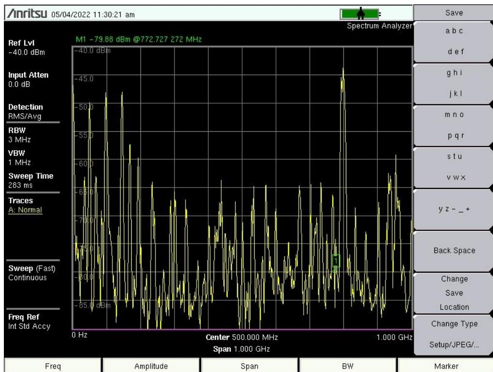
Sl. 8.18 Spektrogram magnetskog polja mjereno okomito u ovisnosti o frekvenciji koristeći sondu PBS-H4 u mjernoj točki 2
