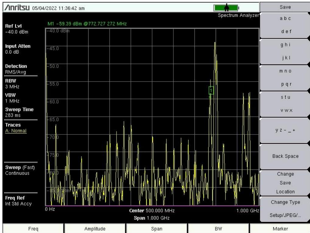
Sl. 8.19. Spektrogram električnog polja mjereno okomito u ovisnosti o frekvenciji koristeći sondu PBS-E1 u mjernoj točki 4
