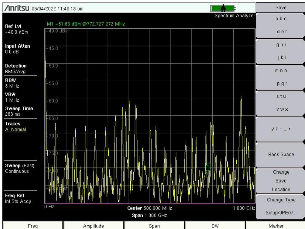
Sl. 8.6 Spektrogram električnog polja mjereno paralelno u ovisnosti o frekvenciji koristeći sondu PBS-E1 u mjernoj točki 2
