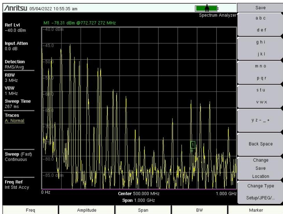
Sl. 4.14. Mjerenje magnetskog polja paralelno u ovisnosti o frekvenciji koristeći sondu PBS-H3 u mjernoj točki 2
