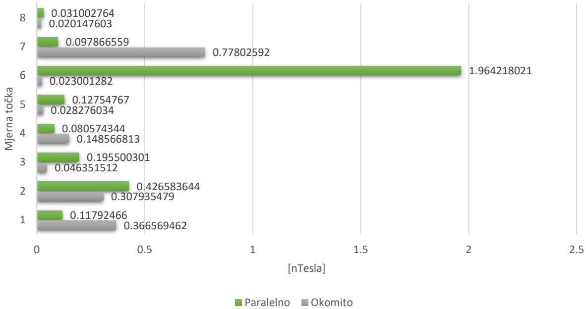
Sl. 4.26. Graf magnetske sonde PBS-H4 koji uspoređuje maksimalne vrijednosti izmjerene okomito i paralelno u mjernim točkama.
