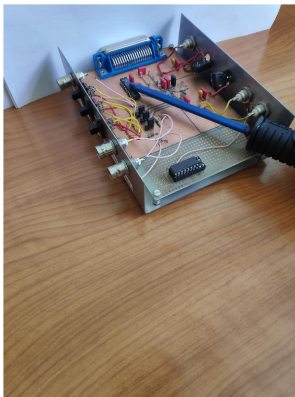
Sl. 4.7. Primjer okomitog mjerenja električne komponente električnom sondom PBS-E1
