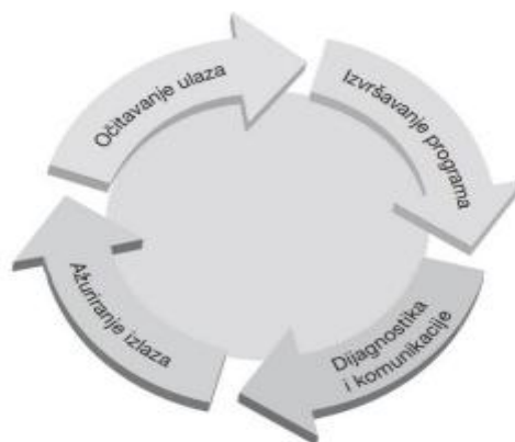
Slika 2.2.: Prikaz cikličkog izvršavanja programa [4]
