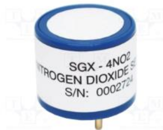
Slika 3.3. Prikaz elektrokemijskog senzora SGX-NO2
