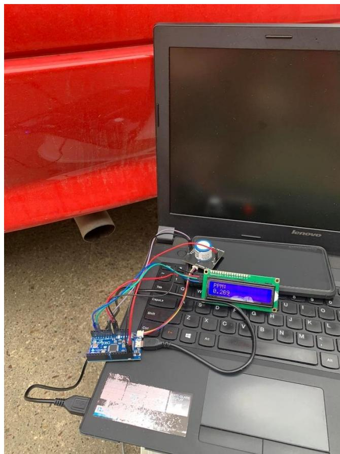
**Slika 4.1.** Priprema uređaja za mjerjenje
