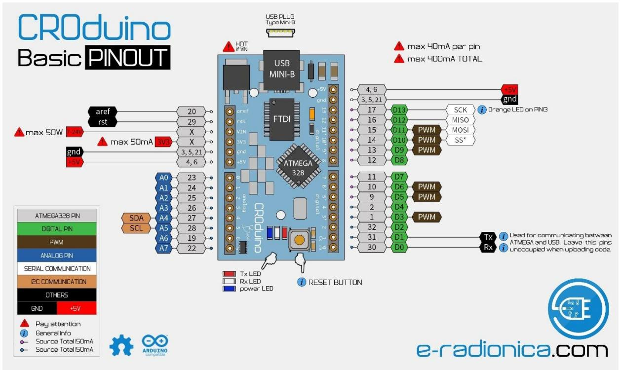
Slika 3.2. Detaljan prikaz nožica i detalja Croduino Basic-a
