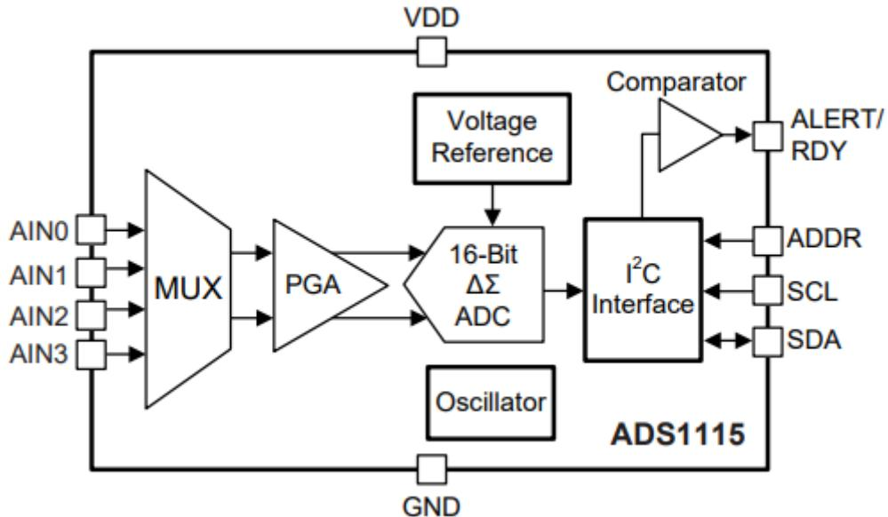
**Slika 3.7.** Prikaz jednostavnog blok dijagrama ADS1115
