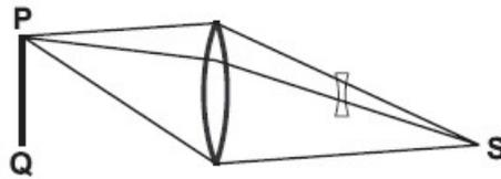
Sl. 4.1. Raspored elemenata Galilejevog teleskopa [8].
