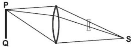
Sl. 4.1. Raspored elemenata Galilejevog teleskopa [8].
