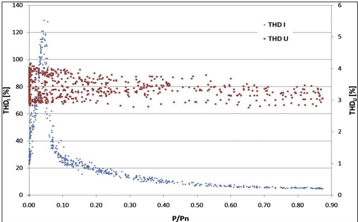
Slika 5.17. Dijagram THD-a napona i struje za različite uvjete proizvodnje kod fotonaponskih sustava [9]
