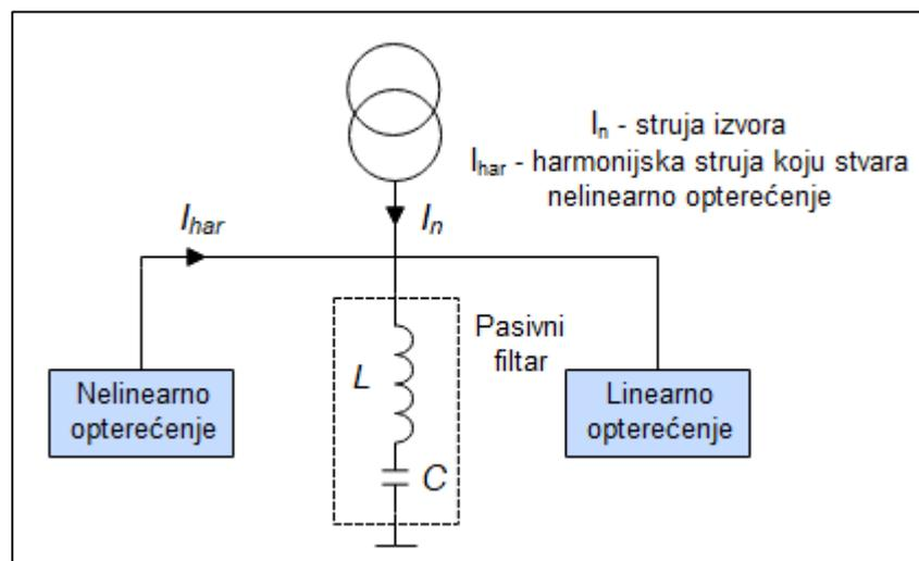
Slika 3.5. Pasivni filter priključen na mrežu [17]
