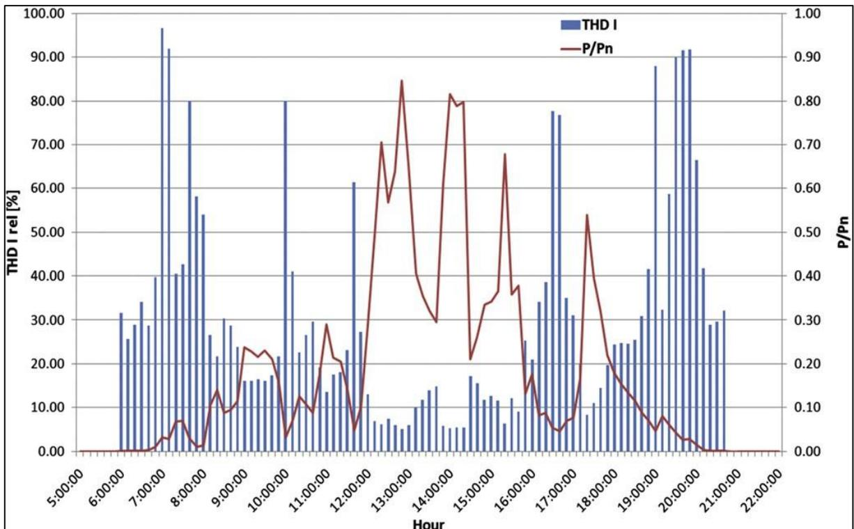
Slika 5.18. Dnevna evolucija proizvedene snage i THD-a struje za fotonaponski sustav [9]
