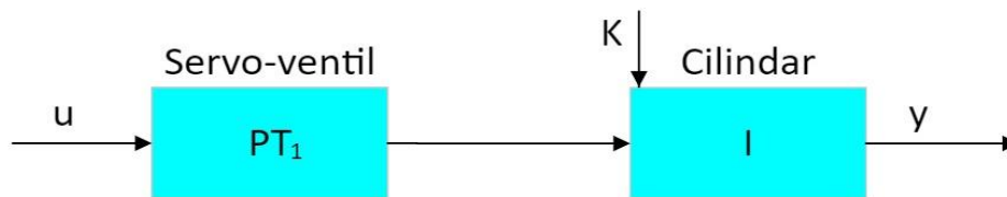
Slika 3.4. Model procesa za podešavanje parametara PI regulatora.
