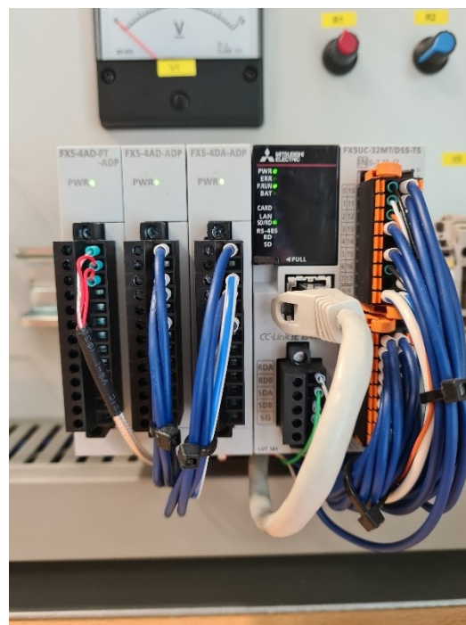
Sl. 2.6 FX5UC-32MT/DSS-TS s adapterima za proširenje na korištenoj maketi
