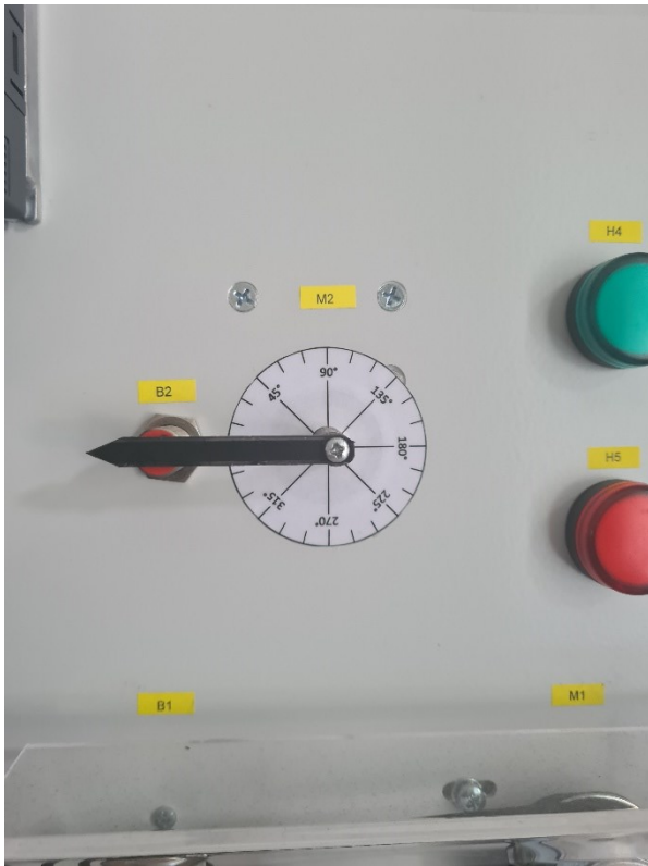
Sl 4.25 Pozicija servomotora prije pokretanja za 45°
