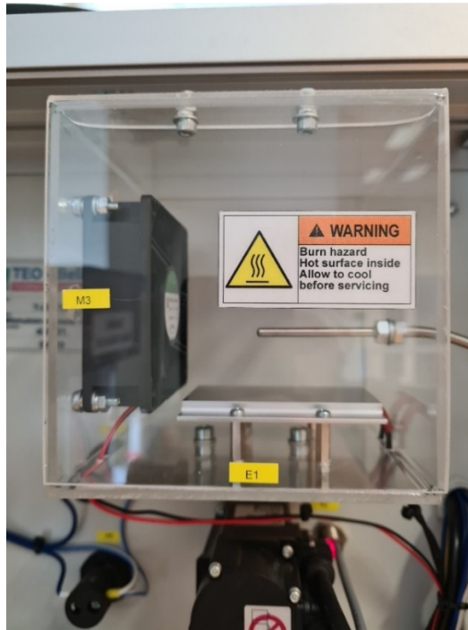
Sl. 3.2 Komora u kojoj se nalaze ventilator, grijač i Pt100 sonda
