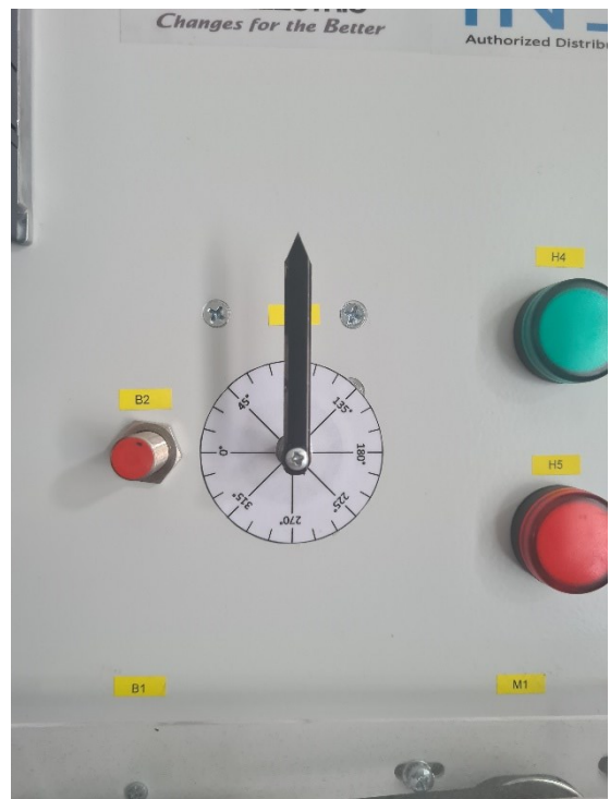
Sl 4.23 Pozicija servomotora nakon pokretanja za 90°
