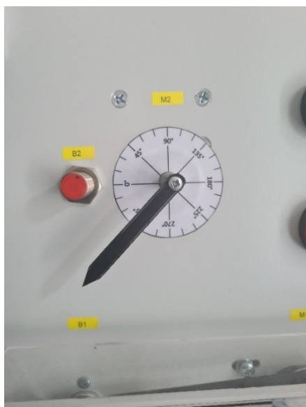
Sl 4.19 Pozicija servomotora prije pokretanja za 180°
