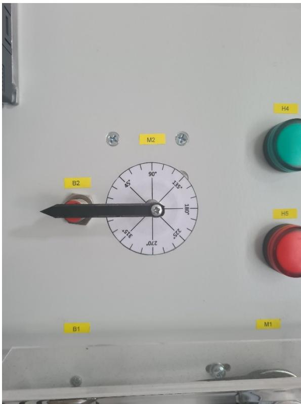
Sl 4.25 Pozicija servomotora prije pokretanja za  $45^\circ$
