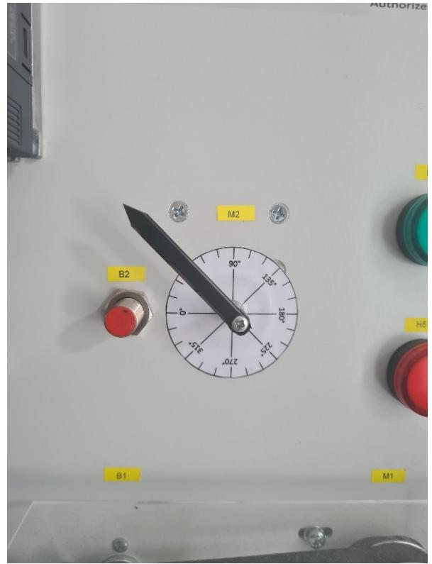
Sl 4.26 Pozicija servomotora nakon pokretanja za  $45^\circ$
