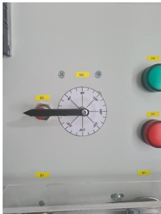
S1 4.22 Pozicija servomotora prije pokretanja za  $90^\circ$
