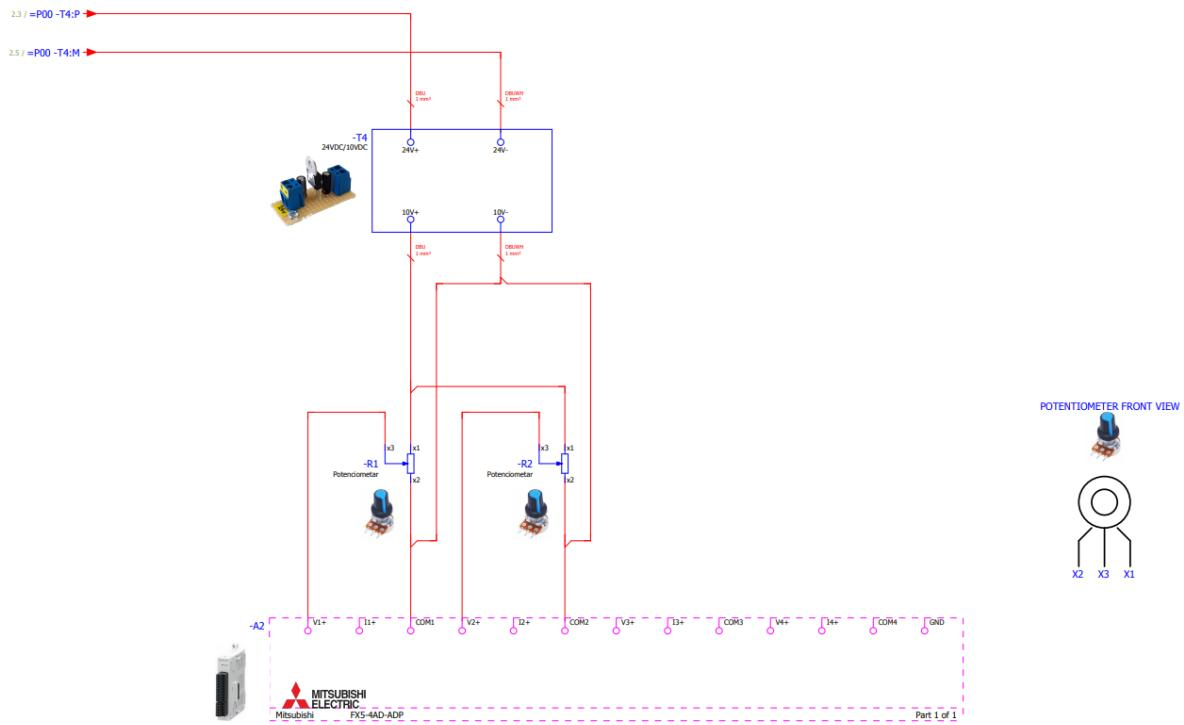
Sl. 2.12 Električna shema spajanja potenciometra na FX5-4AD-ADP [4]
