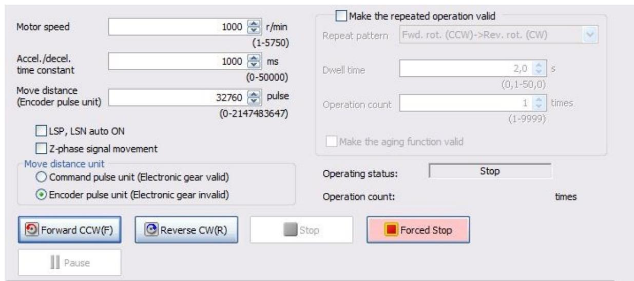
S1 4.21 *Positioning Mode* pri brzini vrtnje motora od 1000 r/min, vrijeme ubrzanja/usporavanja od 1000 ms i pomaka od 32760 pulseva ( $90^\circ$ )
