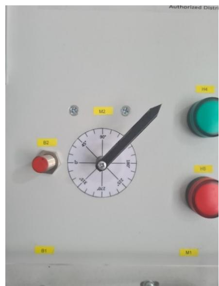
S1 4.20 Pozicija servomotora nakon pokretanja za  $180^\circ$
