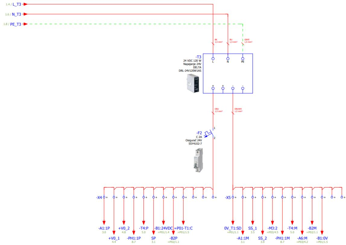
S1. 2.24 Električna shema spajanja napajanje 24 VDC
