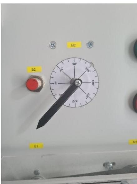
S1 4.19 Pozicija servomotora prije pokretanja za  $180^\circ$
