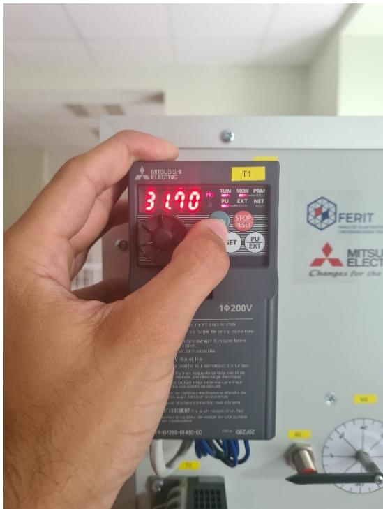
Sl. 4.12 Postavljanje željene frekvencije i pokretanje asinkronog motora
