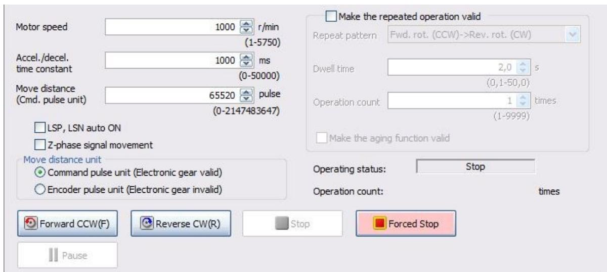
S1 4.18 *Positioning Mode* pri brzini vrtnje motora od 1000 r/min, vrijeme ubrzanja/usporavanja od 1000 ms i pomaka od 65520 pulseva ( $180^\circ$ )
