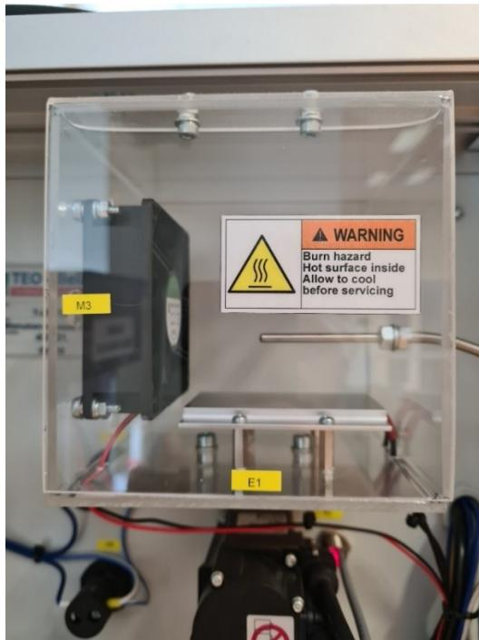
Sl. 3.2 Komora u kojoj se nalaze ventilator, grijач i Pt100 sonda
