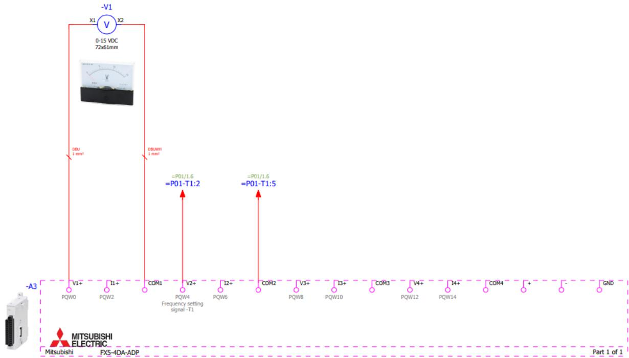
Sl. 2.13 Električna shema spajanja voltmetra na FX5-4DA-ADP [4]
