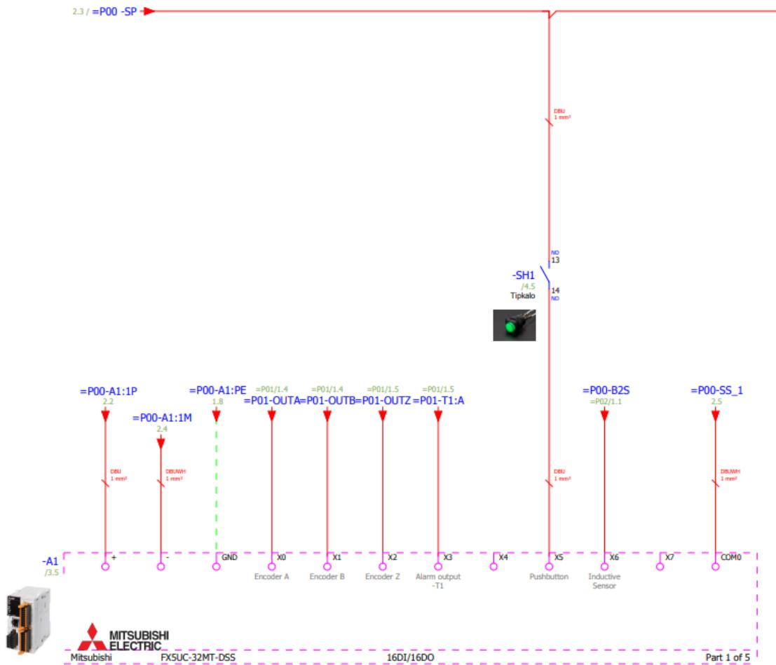
S1. 2.7 Električna shema spajanja enkodera i tipkala na FX5UC [4]
