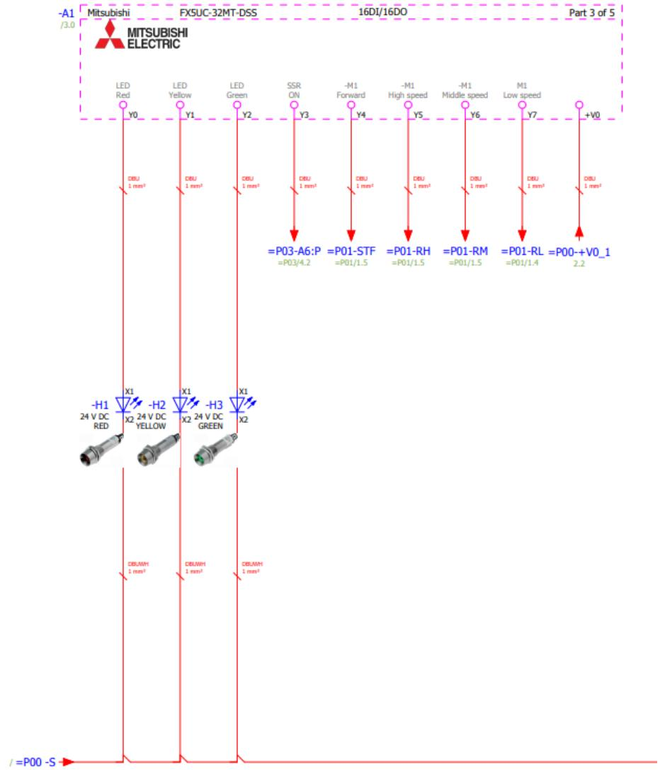
Sl. 2.9 Električna shema spajanja svjetla, tipkala, grijaca i frekvencijskog pretvarača na FX5UC [4]
