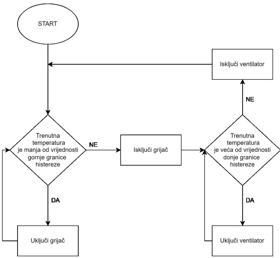
Sl. 3.1 Blok dijagram algoritma za automatsku regulaciju temperature
