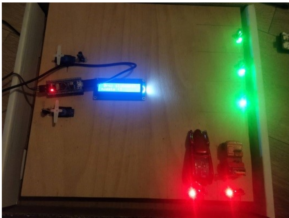
Slika 4.4. Prikaz testiranja funkcionalnosti drugog parkirnog mjesta
