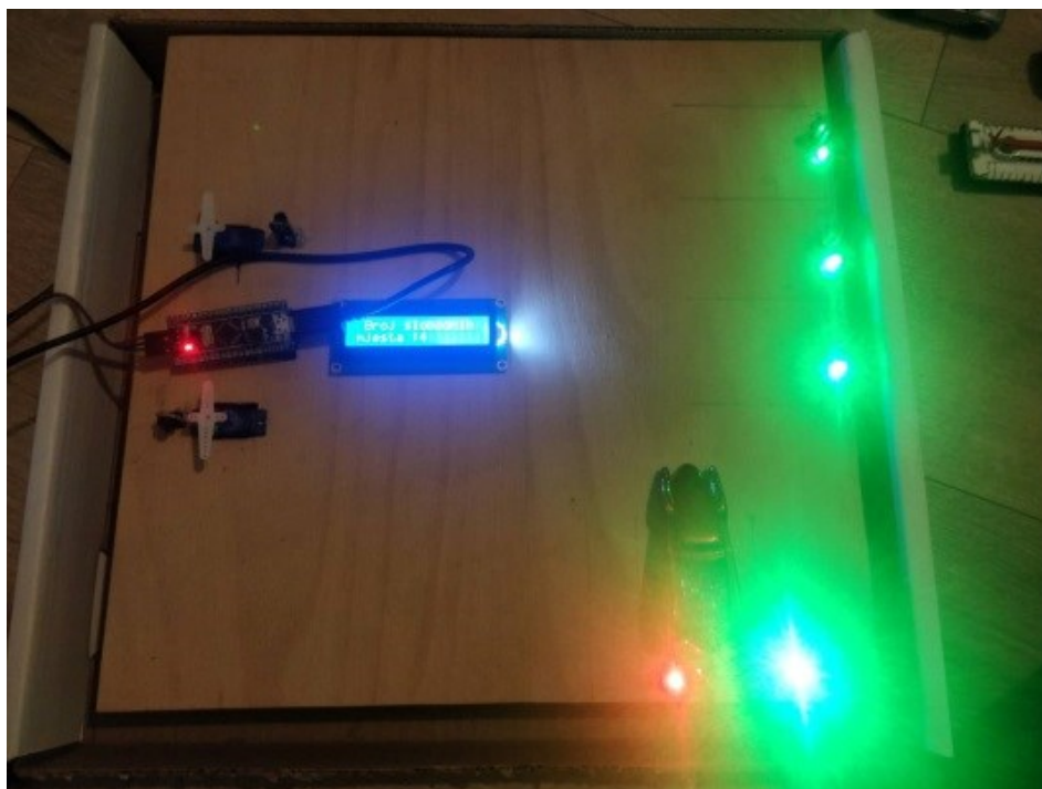
Slika 4.3. Prikaz testiranja funkcionalnosti prvog parkirnog mjesta
