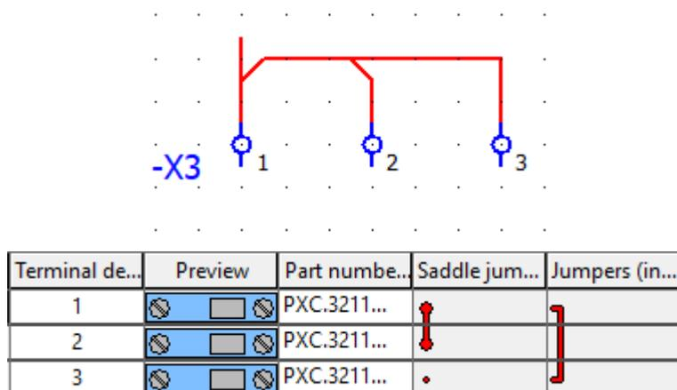
Slika 3.231. Primjer 2, shema i prikaz povezivanja stezaljki
