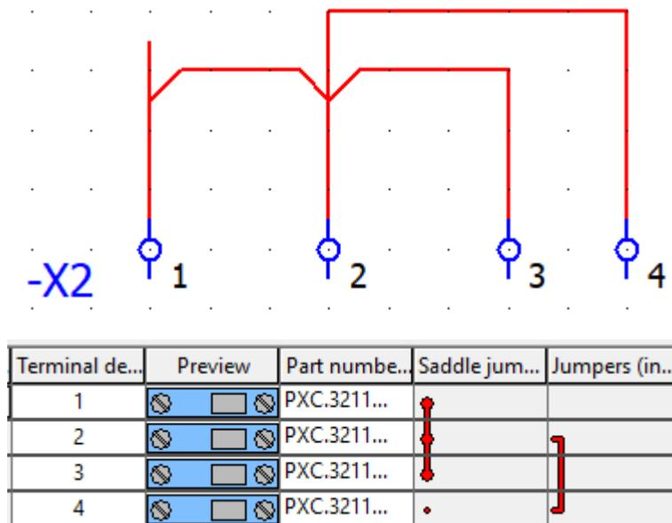
Slika 3.232. Primjer 3, shema i prikaz povezivanja stezaljki
