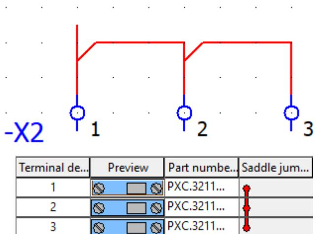
Slika 3.230. Primjer 1, shema i prikaz povezivanja stezaljki
