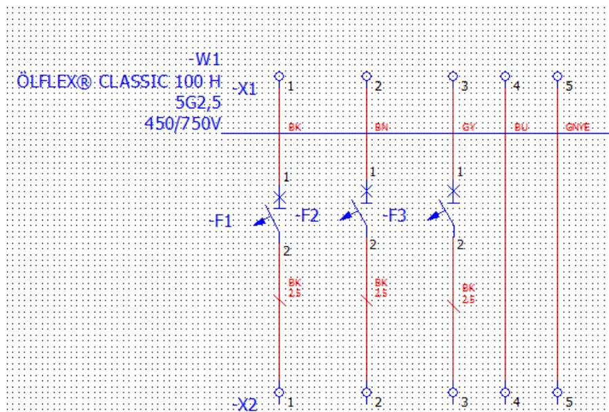
Slika 3.270. Elektrotehnička shema sa definiranim uređajima i kabelima
