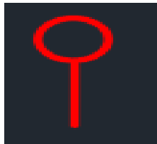
SI.4.4. Izvod za priključenje jednofaznog trošila
