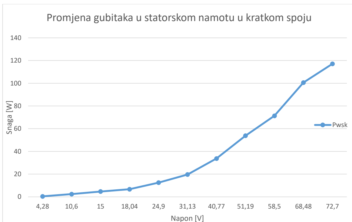
Sl. 6.5. Graf promjene gubitaka u statorskom namotu
