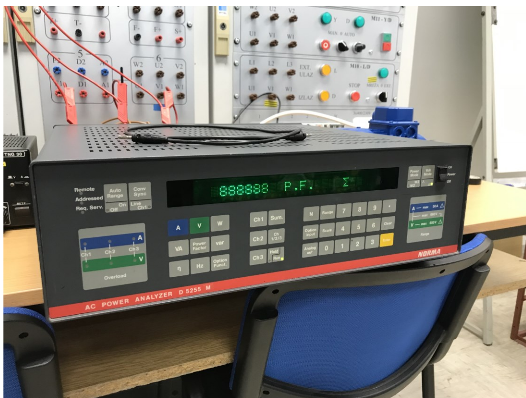
Sl. 4.2. Trofazni analizator snage NORMA
