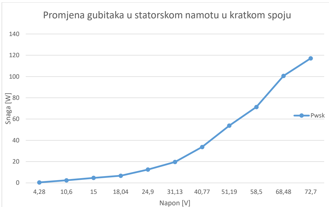
Sl. 6.5. Graf promjene gubitaka u statorskom namotu
