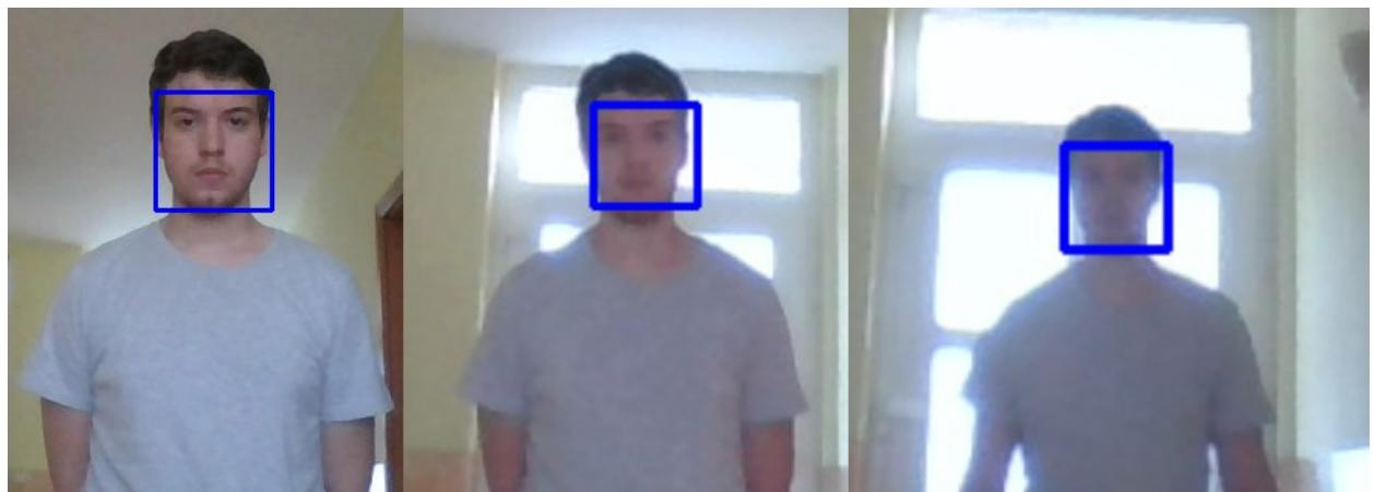
Slika 4.1. Primjer detekcije lica bez okluzija na 1, 3 i 5 metara udaljenosti od kamere
