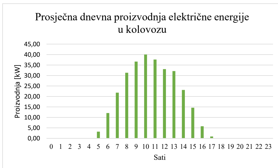
Slika 4.11. : Prosječna dnevna proizvodnja električne energije u kolovožu
