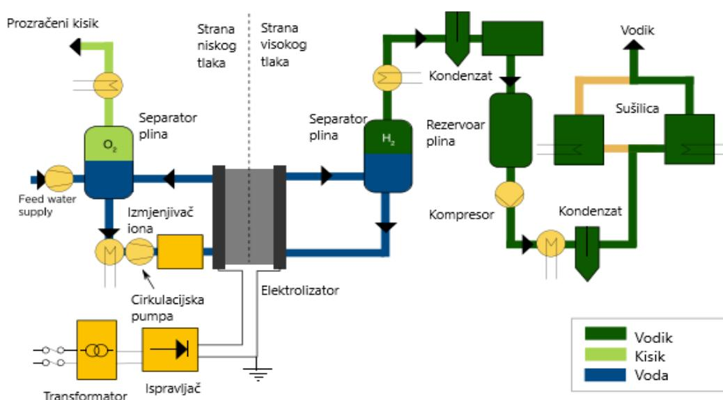
Slika 2.4. : Sustav elektrolizatora za protone s izmjenjivačkom membranom [5]
