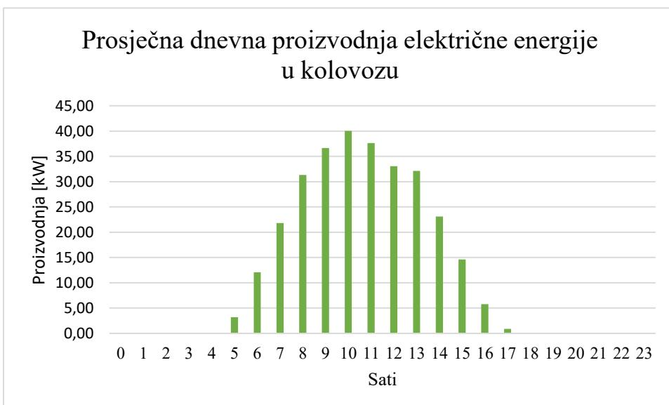
Slika 4.11. : Prosječna dnevna proizvodnja električne energije u kolovozu
