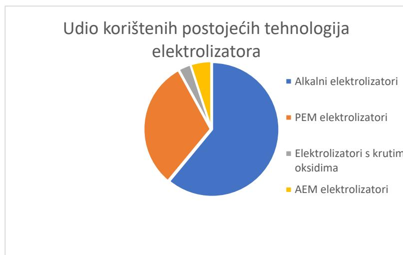
Slika 2.7. : Udio postojećih tehnologija elektrolizatora [4]
