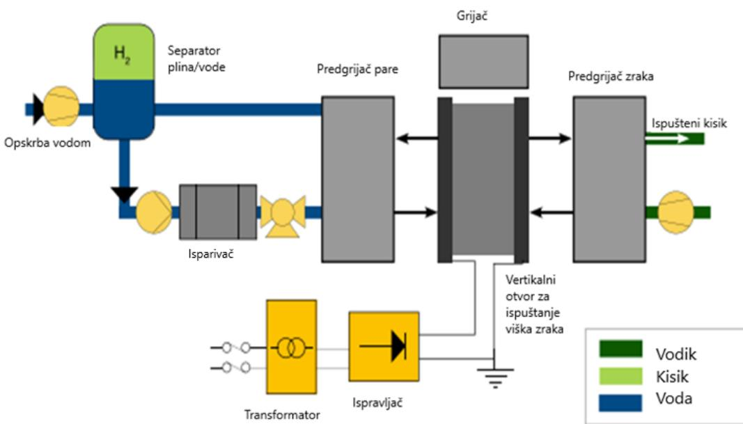
Slika 2.6. : Sustav elektrolizatora s krutim oksidima [5]
