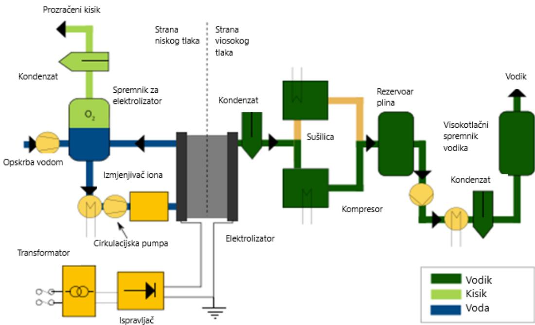
Slika 2.5. : Sustav elektrolizatora za anione s izmjenjivačkom membranom [5]
