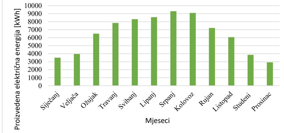
Slika 4.9. : Simulacija mjesecne proizvedene električne energije FN elektrane 64 kW putem PVGIS alata
