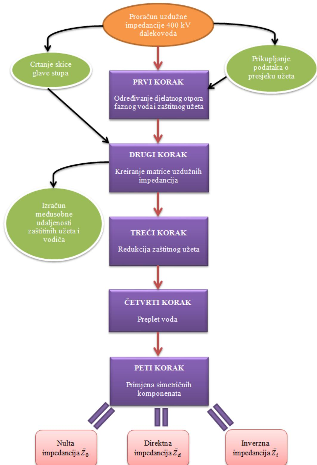
Slika 4.1. Dijagram toka proračuna uzdužne impedancije dalekovoda
