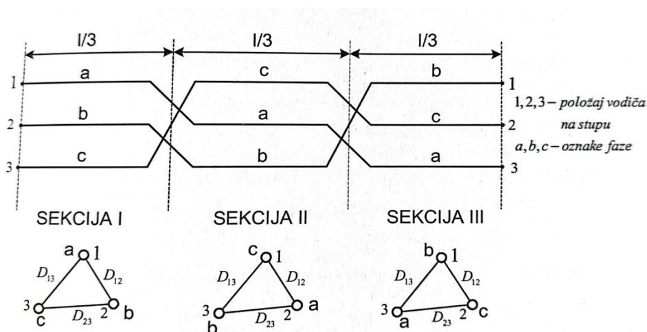
Slika 3.3. Preplet vodiča nesimetričnog trofaznog voda [2]
