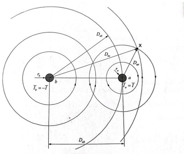
**Slika 3.2.** Silnice magnetskog polja u okolini dva paralelna beskonačna ravna vodiča punog kružnog presjeka [2]
