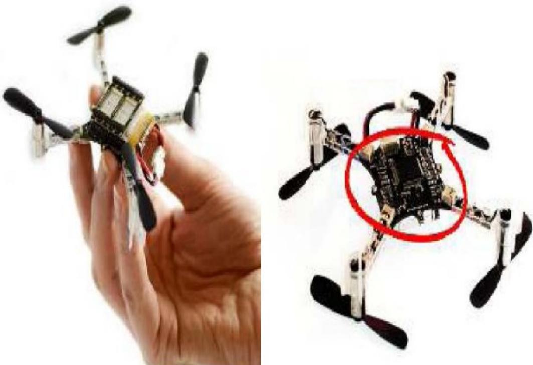
Sl. 4.3. Primjer drona s prikazom gdje se nalazi RFID antena [14]
