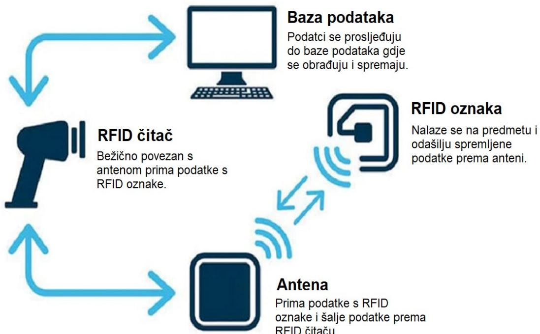
Sl. 4.2. Princip rada RFID tehnologije [13]
