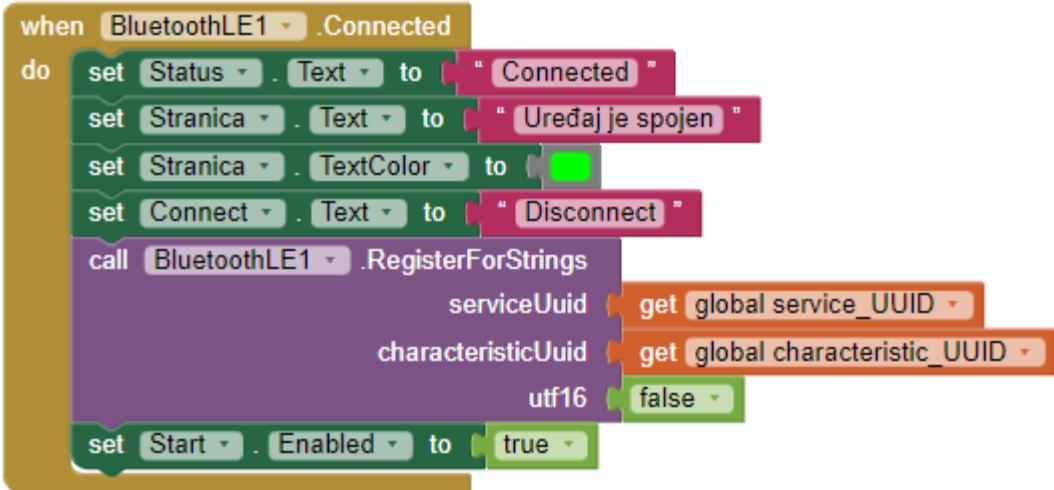
Slika 5.14. Dio koda koji se pokreće prilikom uspješne konekcije s *bluetooth* uređajem.
