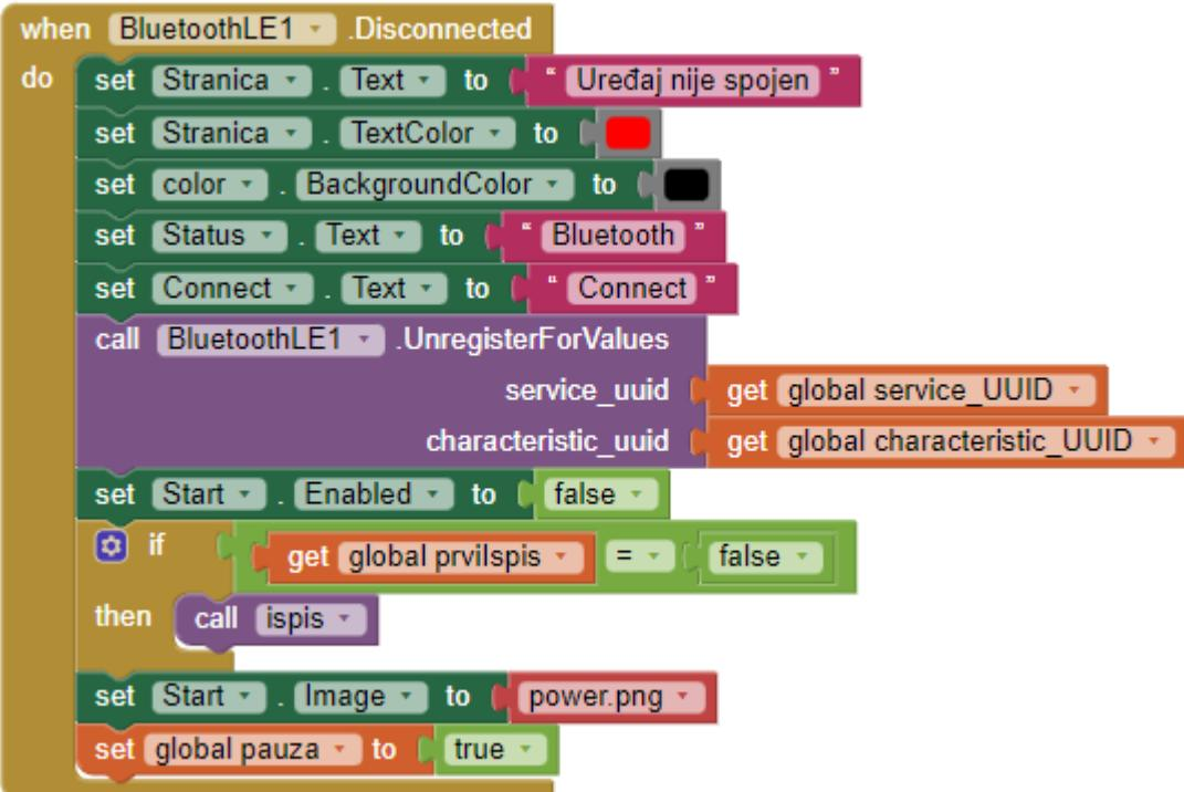
Slika 5.15. Dio koda koji se pokreće kada je *bluetooth* uređaj odspojen.
