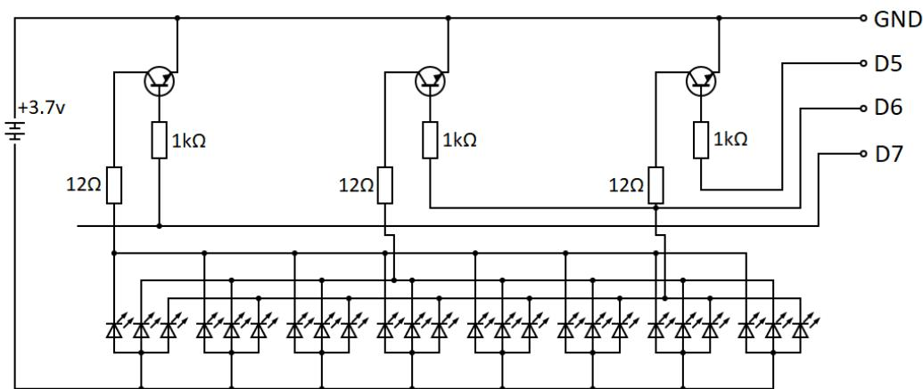
Slika 4.3. Shematski prikaz sklopke za upravljanje diodama.
