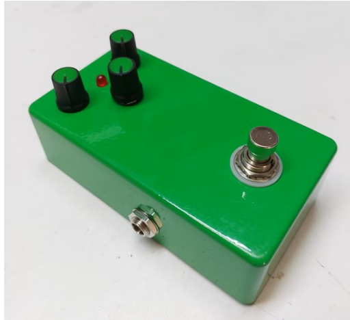
Slika 4.10 Aluminijsko kućište gitarske-efekt pedale
