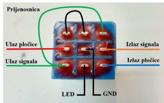
Slika 4.9 Način spajanja 3PDT sklopke
