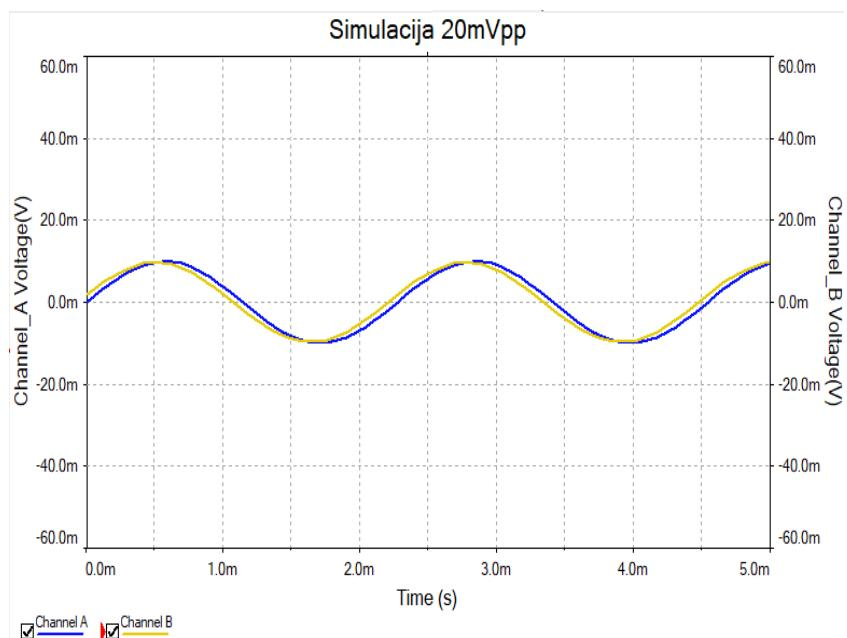
Graf 5.12 Simulacija ulaznog signala iznosa 20mVpp i izlaznog signala
