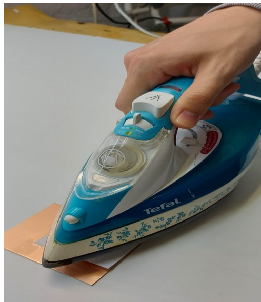
Slika 4.2 Termička obrada pomoću glačala
