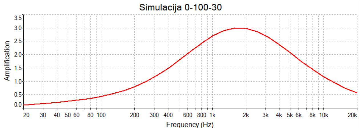
Graf 5.22 Frekvencijski odziv računalne simulacije s kontrolama pedale postavljenim na 0-100-30
