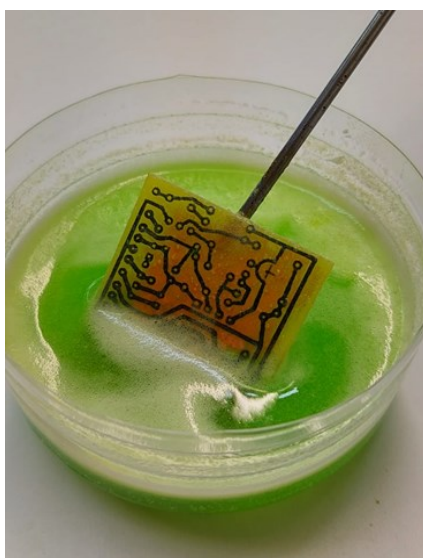
Slika 4.4 Kemijska reakcija na bakrenoj pločici
