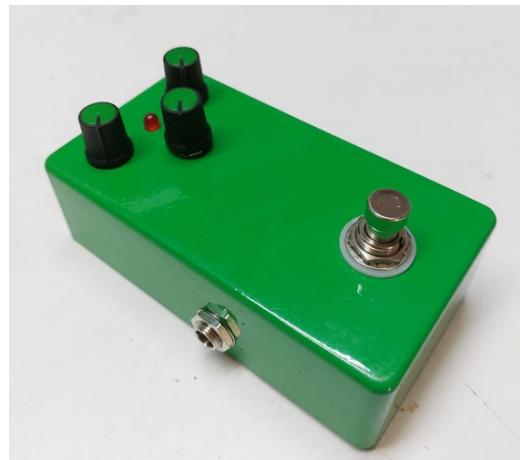
Slika 4.10 Aluminijsko kućište gitarske-efekt pedale
