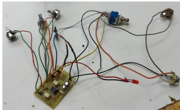
Slika 4.7 Izgled PCB pločice sa svim elementima
