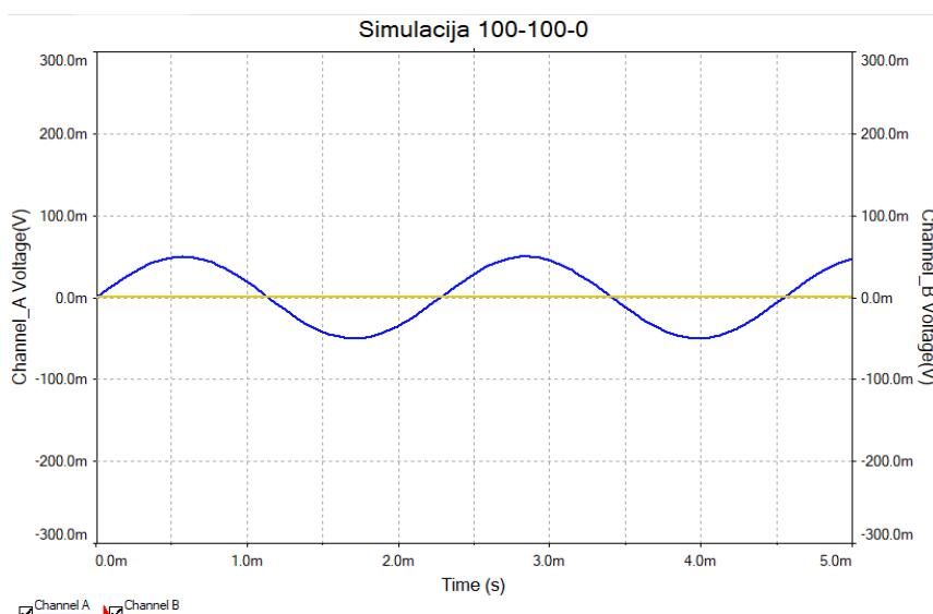
Graf 5.1 Simulacija ulaznog i izlaznog signala s kontrolama pedale postavljenim na 100 - 100 - 0
