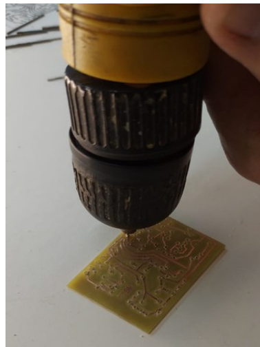
Slika 4.6 Bušenje rupa na predviđenim mjestima
