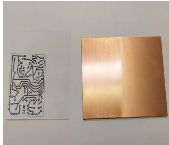
Slika 4.1 Očišćena tiskana pločica i predložak s vodovima
