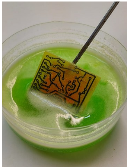
Slika 4.4 Kemijska reakcija na bakrenoj pločici
