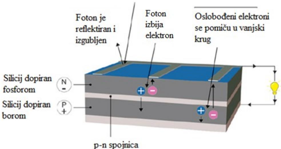
Slika 2.5. Prikaz principa rada solarne čelije [6]
