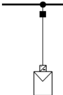
Slika 4.3. Simbol fotonaponskog sustava u DIgSILENT PowerFactory programu [11]
