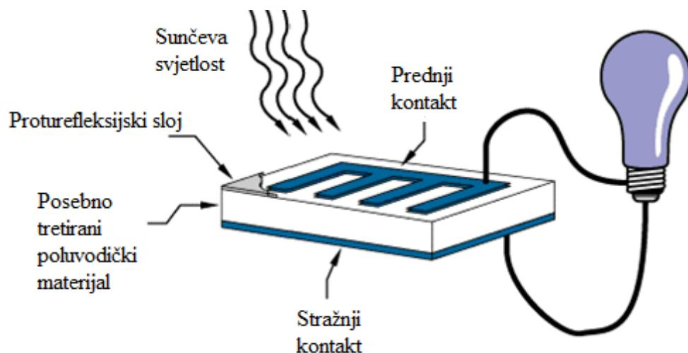
Slika 2.4. Osnovni prikaz dijelova solarne ćelije [5]
