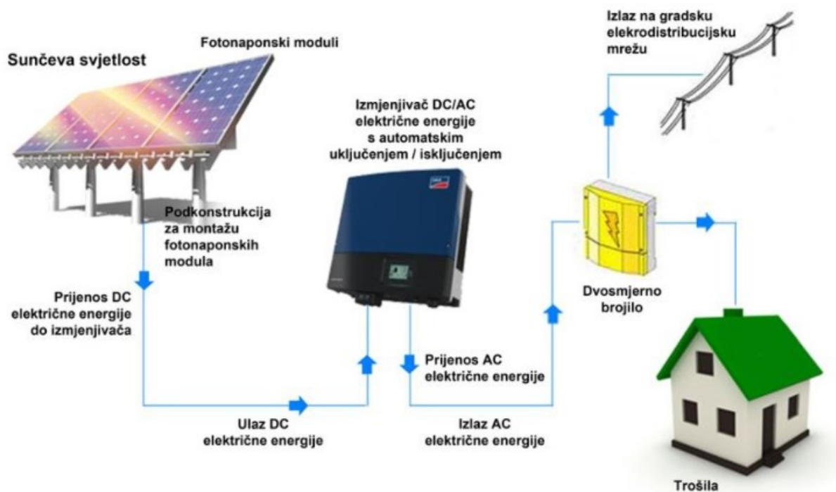
Slika 2.2. Umreženi fotonaponski sustav [2]
